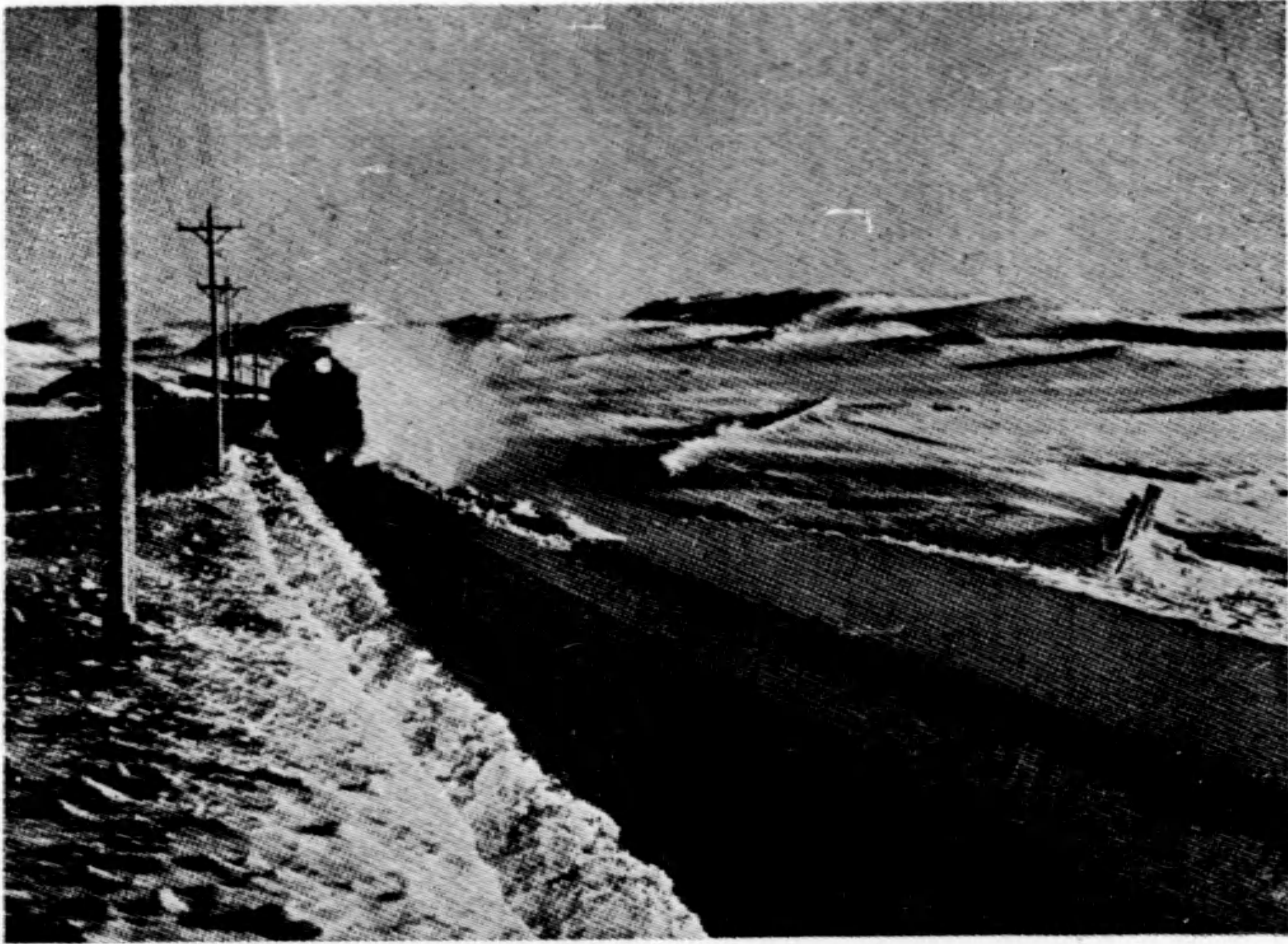
(三) 冬季沃司羅勃根快車行近芬斯之情形 (旋轉雪犁已將軌道清出，機車緩衝樑上並添設V形之犁)
