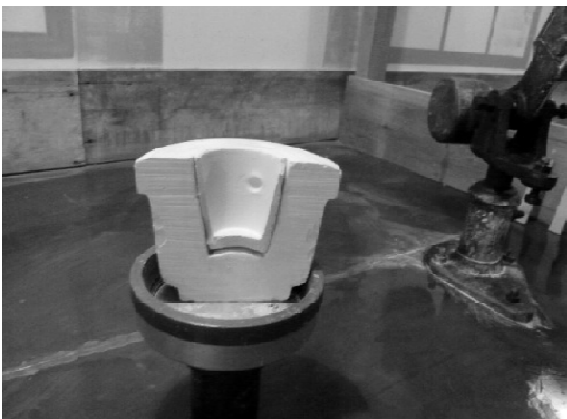
Aufgeschnittene Gipsform mit Rohscherben
