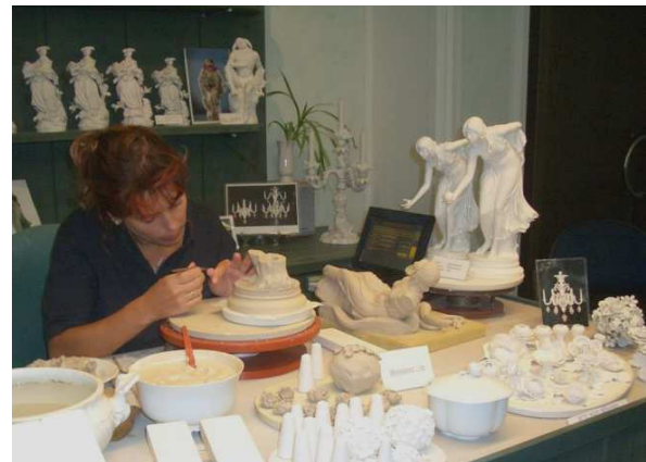
Bossiererin beim Anbringen von Kleinteilen mit Schlicker (verdünnte Rohmasse)
