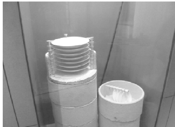
Kapsel zum Schutz der Rohware und um möglichst gleiche Brenntemperatur zu erhalten
