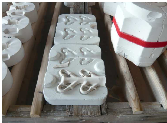
Gipspreß(quetsch)formen für Bossierteile
