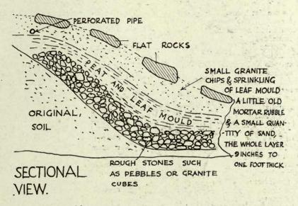
FIG. 386.—CONSTRUCTION OF MORAINE ON SLOPE
