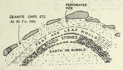
FIG. 387.—CONSTRUCTION OF MORAINE ON LEVEL GROUND.
