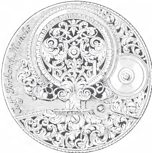
Fig. 4. Obere Platine einer deutschen Uhr, mit Kloben und Stellscheibe, 17. Jahrh.
