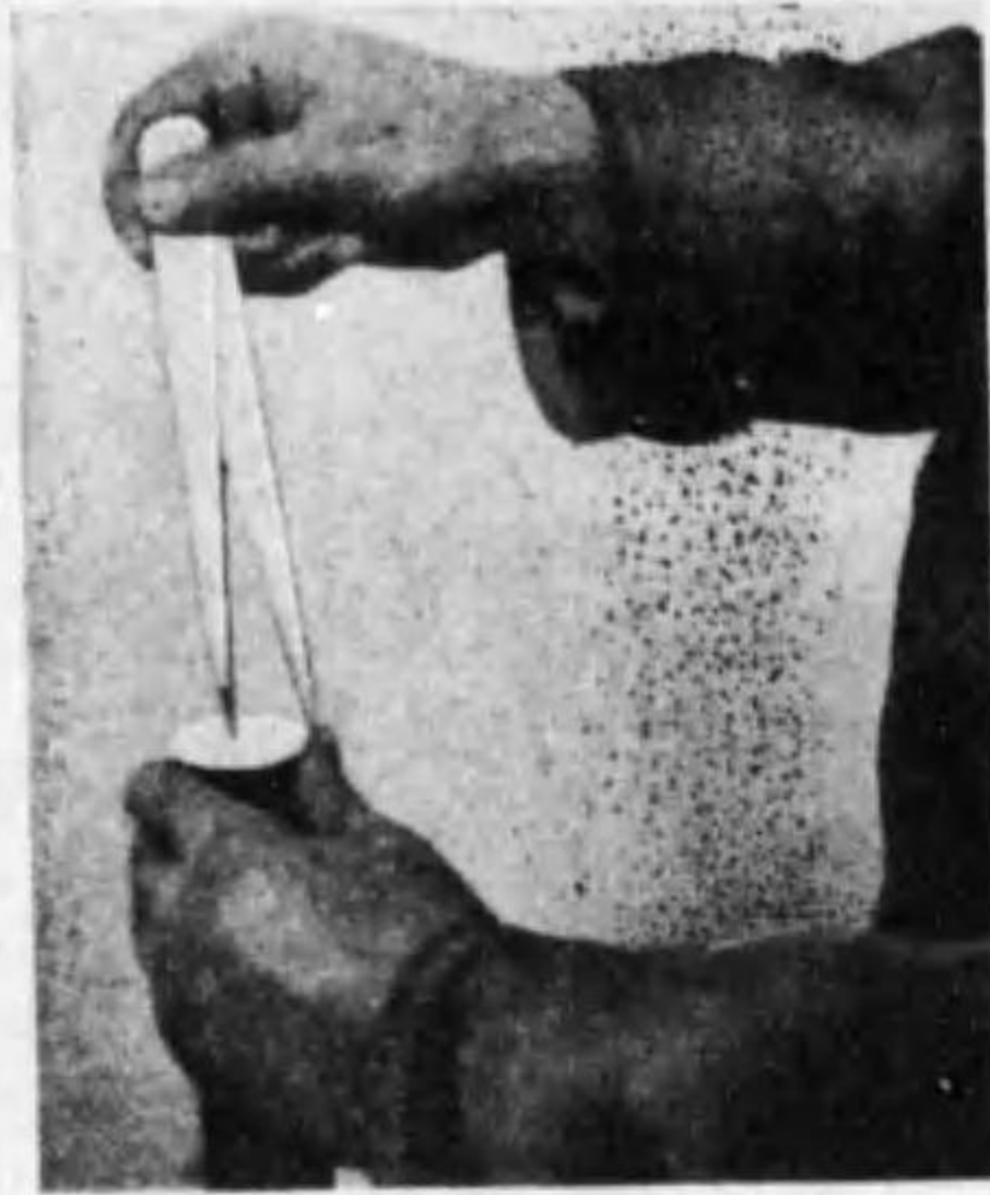
第149圖 片パスによる中心の求め方
