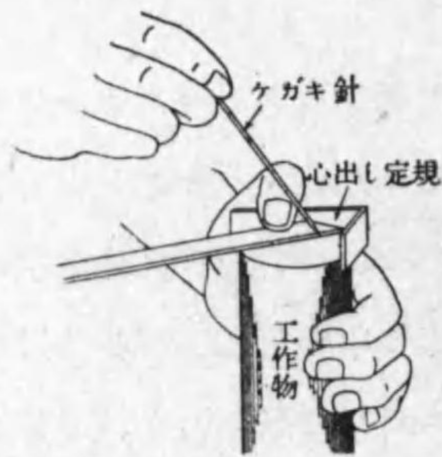
第150圖 心出し定規による中心の求め方
