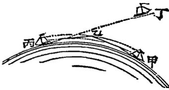
海市蜃樓由於空氣之折光而生。如第五圖甲丙二處相距甚遠，本不能相見，因海面之空氣受海水之影響，溫度較上層空氣之溫度為低，遂生折光作用，由甲折至乙，遂
