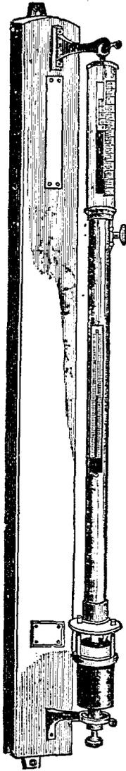
袋內亦有水銀，氣壓高，則袋中之水銀升入於管。氣壓低，則管中之水銀回入於袋，管中水銀之高，在
