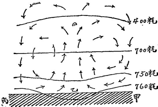
圖中 指針 表示 風之 方向 曲線 表示 氣壓
