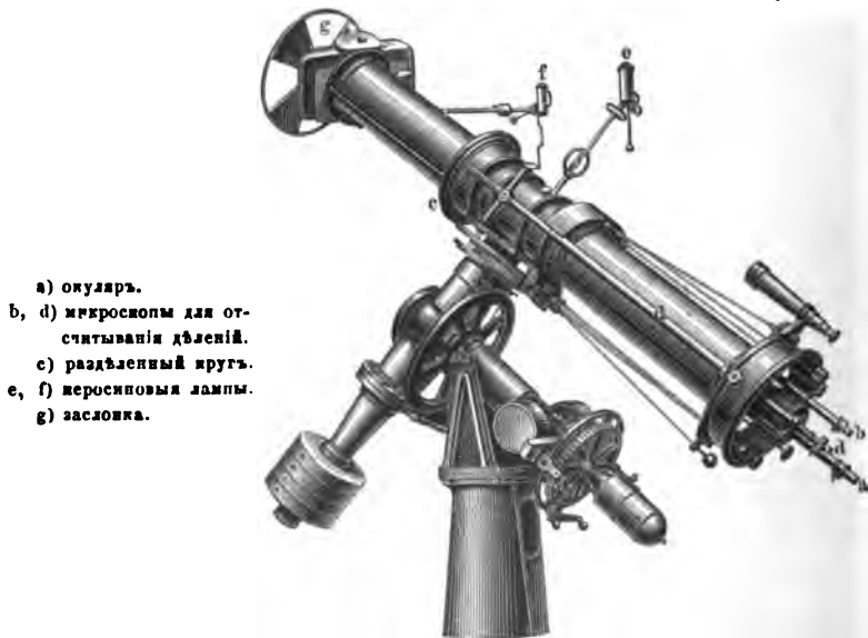
Фиг. 4. Гелиометръ Обсерваторіи въ Нью-Гавенѣ (Съв. Ам.). Построенъ бр. Реппольдъ въ Гамбургѣ.
