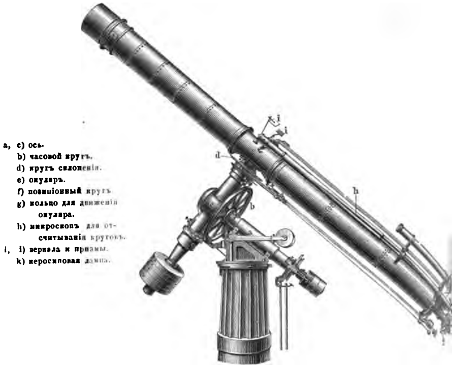
Фиг. 2. Большой рефракторъ Страсбургской Обсерваторіи. Объективъ Мерца въ Мюнхенѣ, механическая часть бр. Реппольдъ въ Гамб. Диаметръ объектива 48,7 сант., фокусное разстояніе 7 метровъ.
