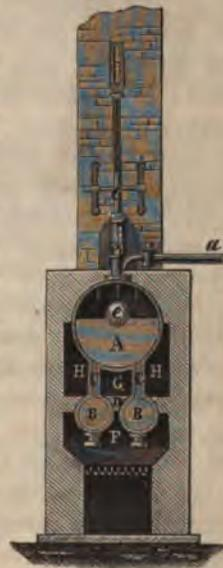
Fig. 403. Dampfesselanlage für Hochdruckmaschinen.
