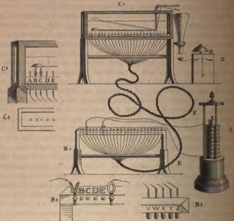
Fig. 289. Der erste galvanische Telegraph von Sömmering.
