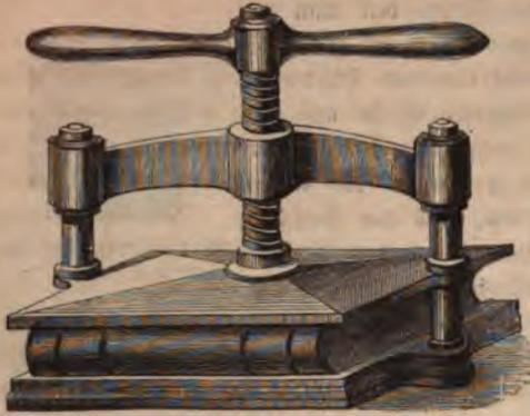
Fig. 17. Schraubenpresse.
