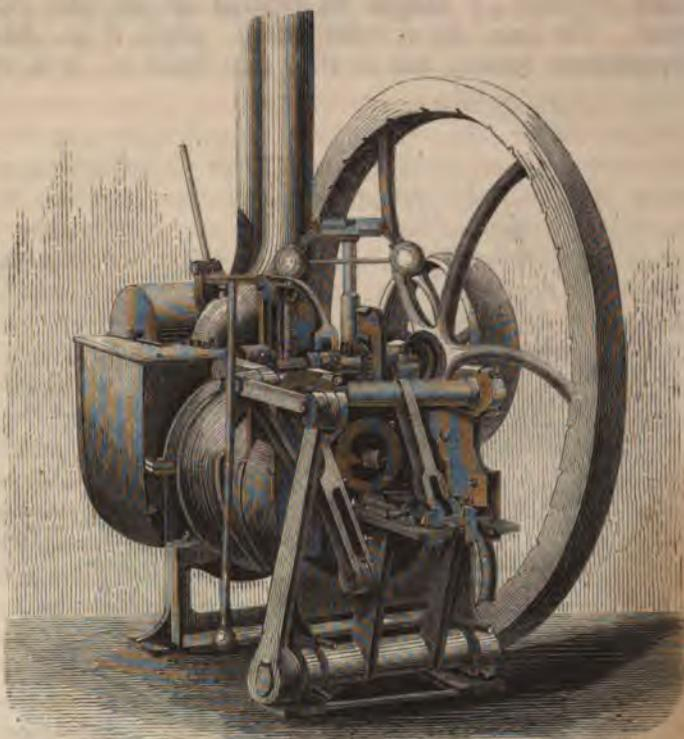
Fig. 408. Ericson's Heißluftmaschine. Vorderansicht.
