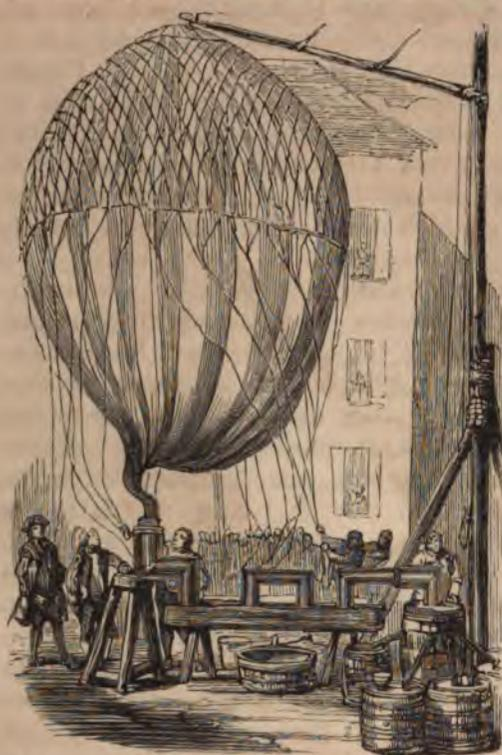
Fig. 96. Das Füllen des Luftballons mit Wasserstoffgas.
