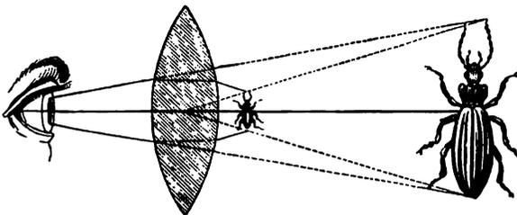
Fig. 195. Virtuelles Bild konvexer Linsen.
