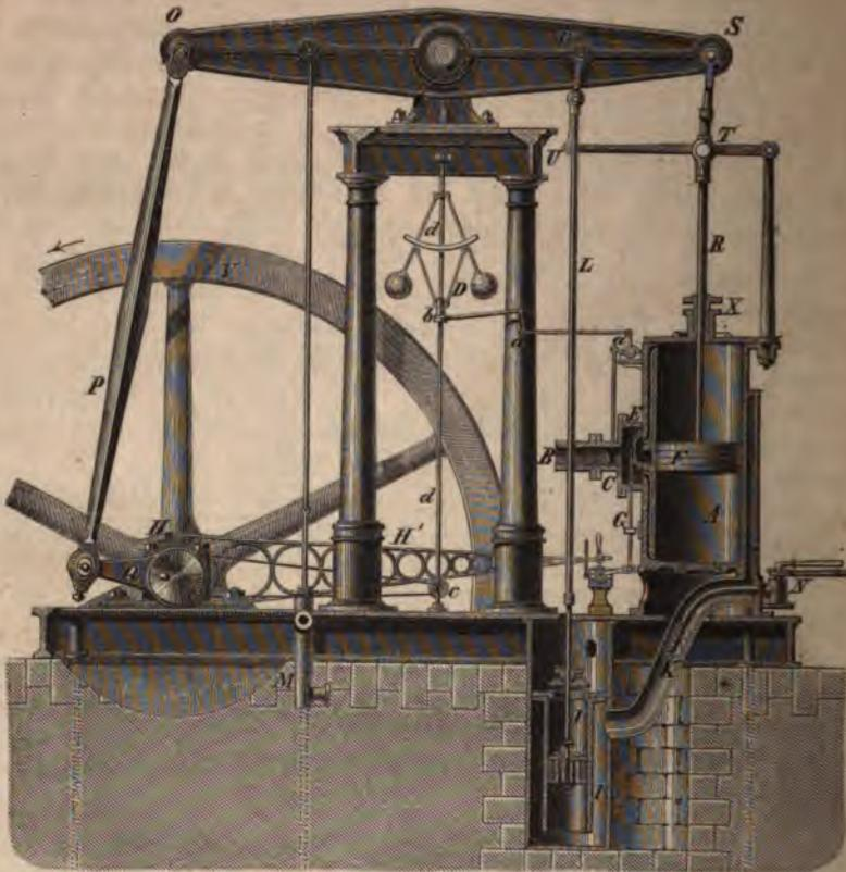
Fig. 395. Dampfmaschine nach Watt, neuerer Konstruktion. A Dampfcylinder. F Kolben, X Stopfbüchse, R Kolbenstange. STUV Parallelogramm. SO Balancier. P Kurbelstange. Q Kurbelzapfen, V Schwungrad, H Excentrif. H' Excentrifstange. G Schiebersteuerung. B Dampfrohr aus dem Kessel. C Drosselklappe. E Ventillader. Dampfbüchse. D Kugelregulator. a a Regulatorhebel. b Verschiebbare Hülse. I Kondensator. J Luftpumpe. K Kaltwasserbrause. N Saugrohr. M Speisepumpe.
