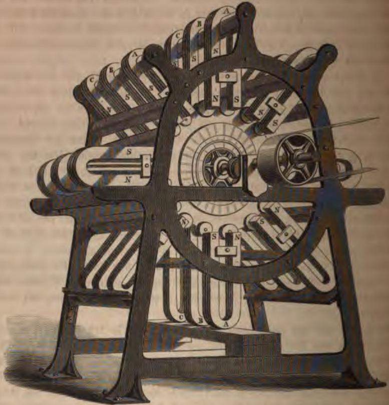
Fig. 284. Rotationsapparat zum Zweck elektrischer Beleuchtung.
