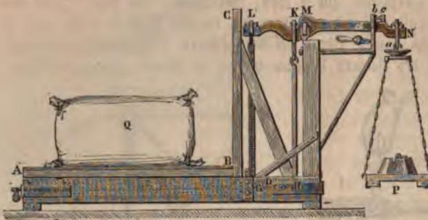
Fig. 54. Brückenwaage.
