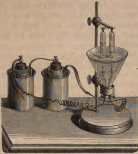
Fig. 271. Wasserzersetzung durch den elektrischen Strom.
