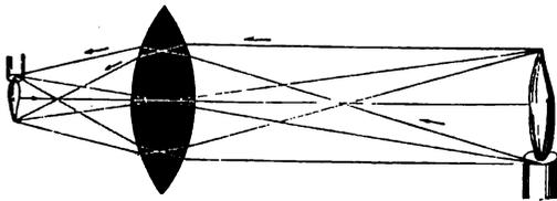
Fig. 194. Reelles Bild der konvexen Linse.
