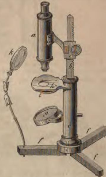
Fig. 241. Zusammengesetztes Mikroskop.
