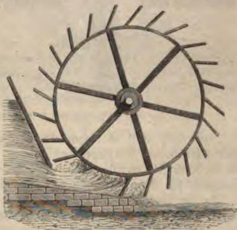
Fig. 135. Unterschlächtiges Wasserrad.
