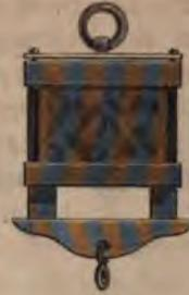
Fig. 305. Armirung des Magnets.
