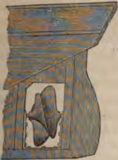
Fig. 22. Doppeltgängige Schiffschraube.
