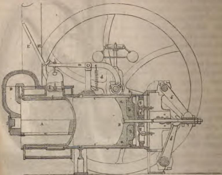
Fig. 409. Ericson's kalorige Maschine. Vertikaldurchschnitt.
