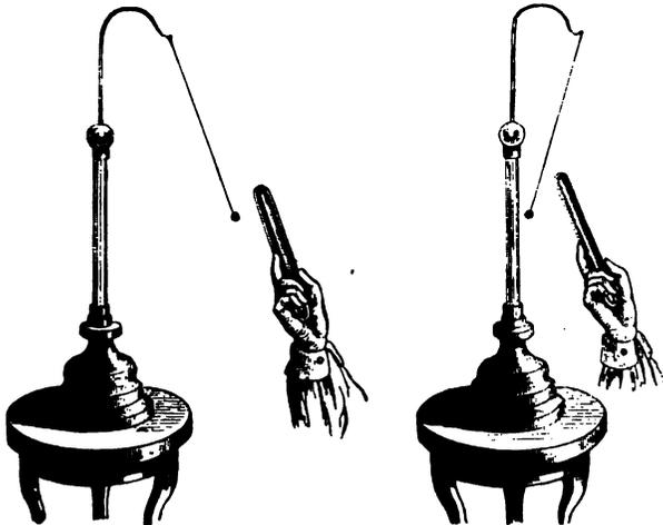
Fig. 251. Elektrisches Pendel.
