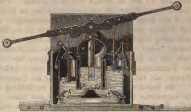
Fig. 156. Feuerspritze im Durchschnitt.
