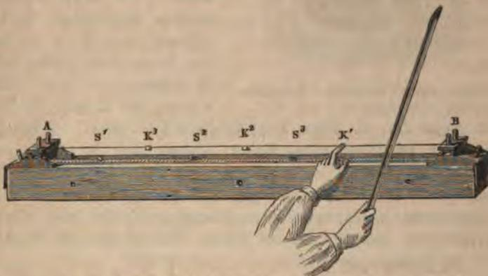
Fig. 321. Entstehung der Schwingungsnoten bei gespannten Saiten.
