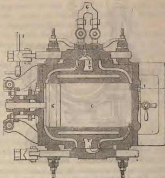
Fig. 405. Venoir's Gasmaschine, Horizontaldurchschnitt.
