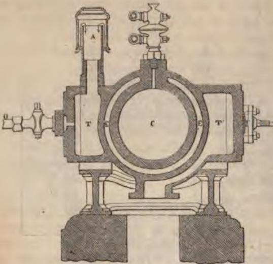
Fig. 406. Lenoir's Gasmaschine. Vertikaldurchschnitt.
