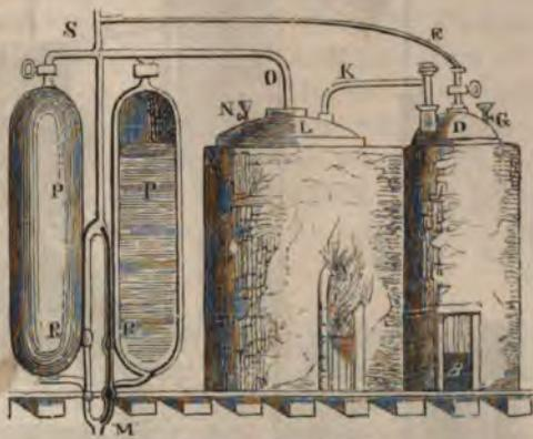
Fig. 391. Savery's Dampfmaschine.
