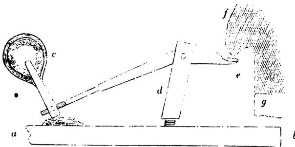
Fig. 341. Schröter'scher Mechanismus.
