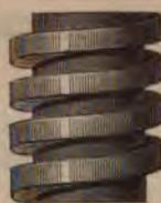
Fig. 14. Schraube mit vierseitigem Querschnitt.
