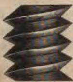
Fig. 13. Schraube mit dreifachtem Querschnitt.
