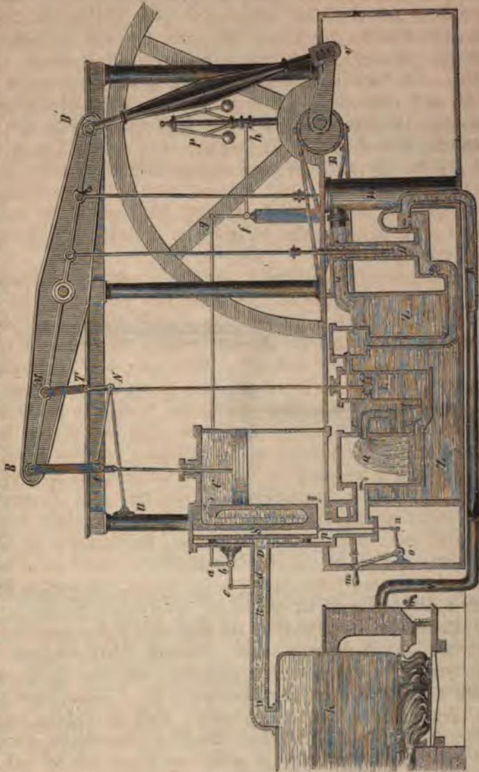
Fig. 393. Watt's doppelwirkende Dampfmaschine.
