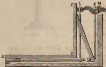
Fig. 55. Innere Einrichtung der Brückenwaage.
