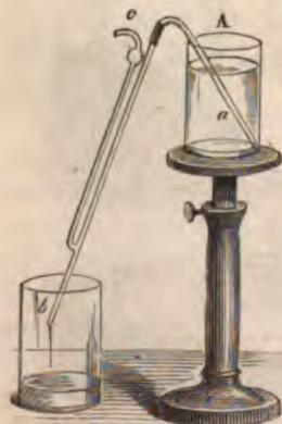
Fig. 133. Saugheber mit besonderer Saugröhre.
