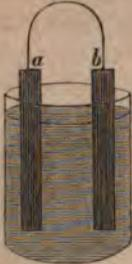
Fig. 265. Galvanisches Element.
