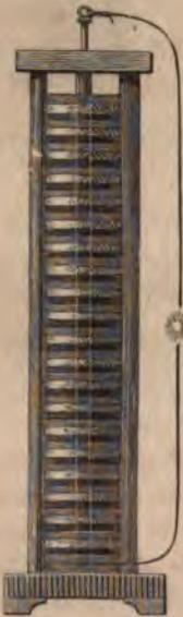
Fig. 266. Die Volta'sche Säule.
