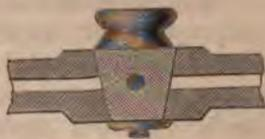
Fig. 116. Senguerd's doppelt durchbohrter Hahn.
