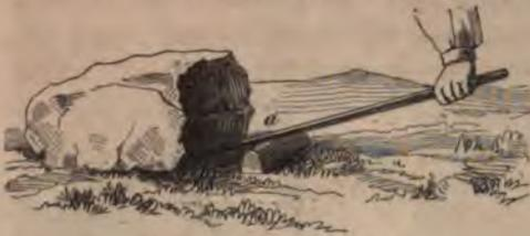
Fig. 28. Zweiarmiger Hebel.
