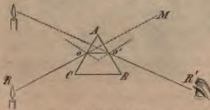
Fig. 180. Brechung des Lichts durch das Prisma.
