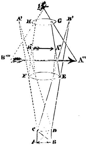
Fig. 210. Prinzip des zusammengesetzten Mikroskops.
