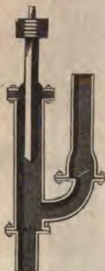
Fig. 150. Druckpumpe mit Mönchskolben.
