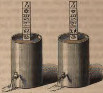
Fig. 288. Hydraulischer Telegraph.
