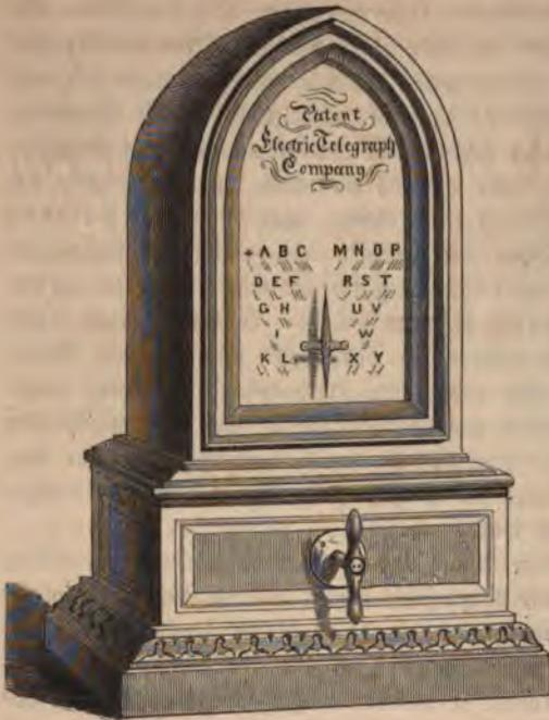
Fig. 290. Der Nadeltelegraph von Wheatstone und Cooke.
