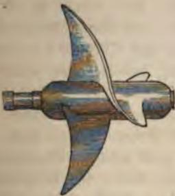
Fig. 23. Doppeltgängige Schiffschraube.
