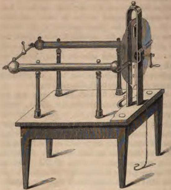
Fig. 252. Elektrirmaschine.
