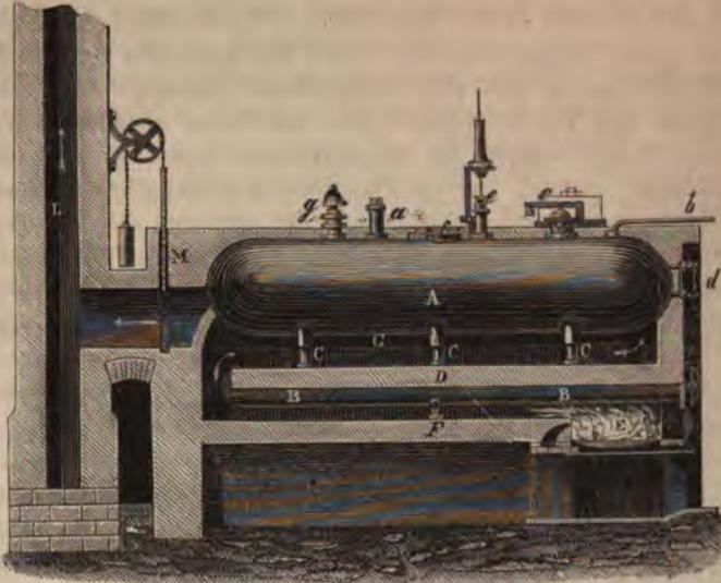
Fig. 402. Dampfesselanlage für Hochdruckmaschinen.
