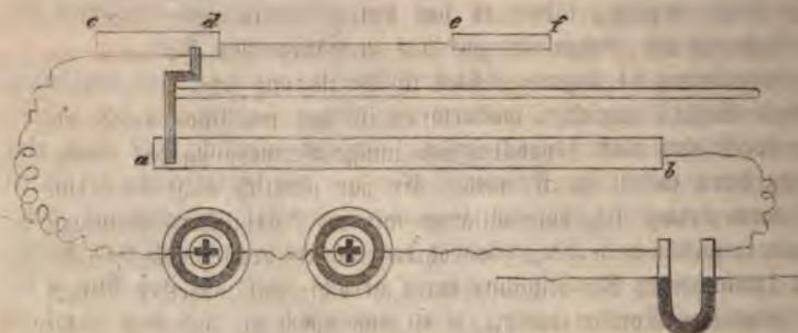
Fig. 407. Der Funken erzeugende Apparat.
