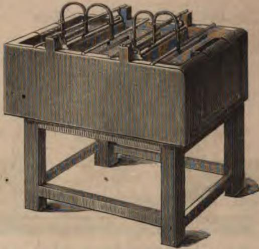
Fig. 274. Galvanoplastischer Apparat für Erzeugung größerer Kupferplatten.
