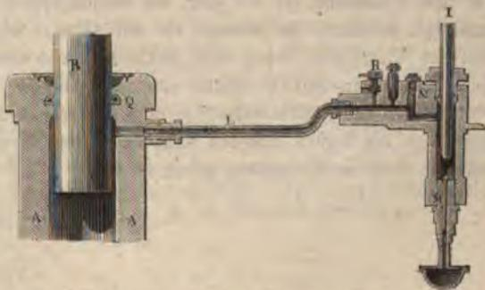
Fig. 158. Durchschnitt der hydraulischen Presse.
