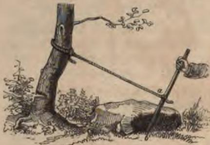
Fig. 29. Einarmiger Hebel.
