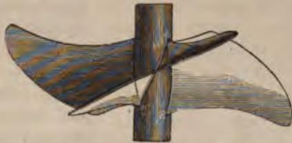
Fig. 24. Viergängige Schiffschraube.
