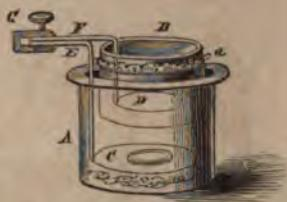
Fig. 272. Galvanoplastischer Apparat.
