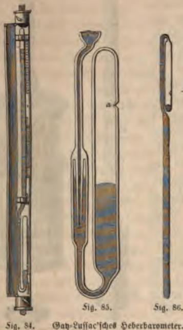
Fig. 84. Gay-Lussac'sches Heberbarometer.
