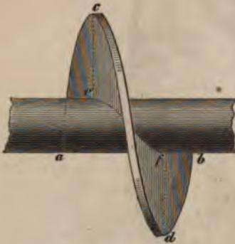
Fig. 21. Erste Form der Schiffsschraube.
