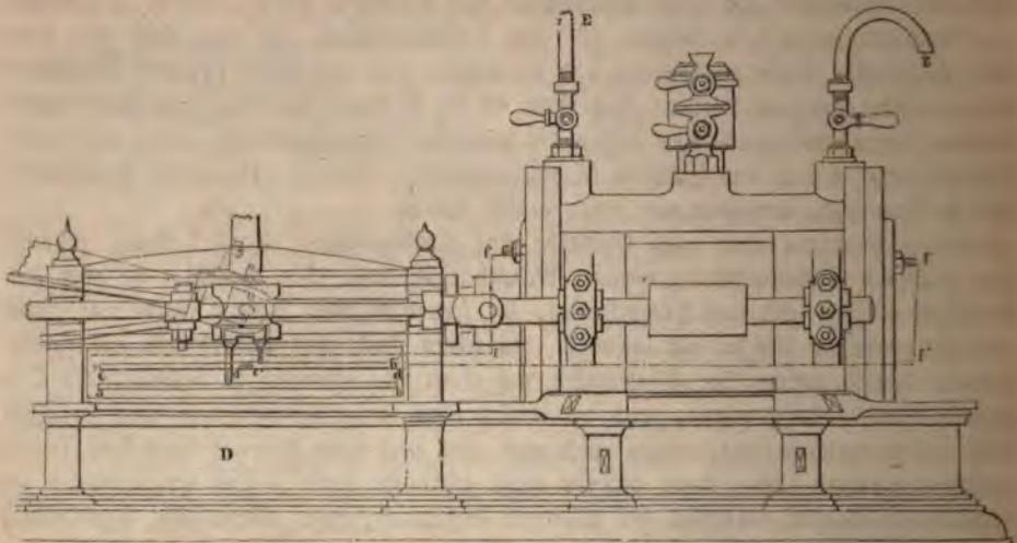
Fig. 404. Lenoir's Gasmaschine. Vorderansicht.
