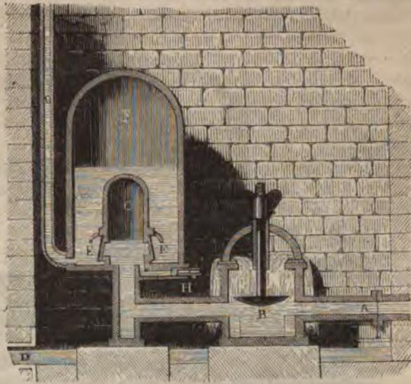
Fig. 152. Der hydraulische Widder von Montgolfier.
