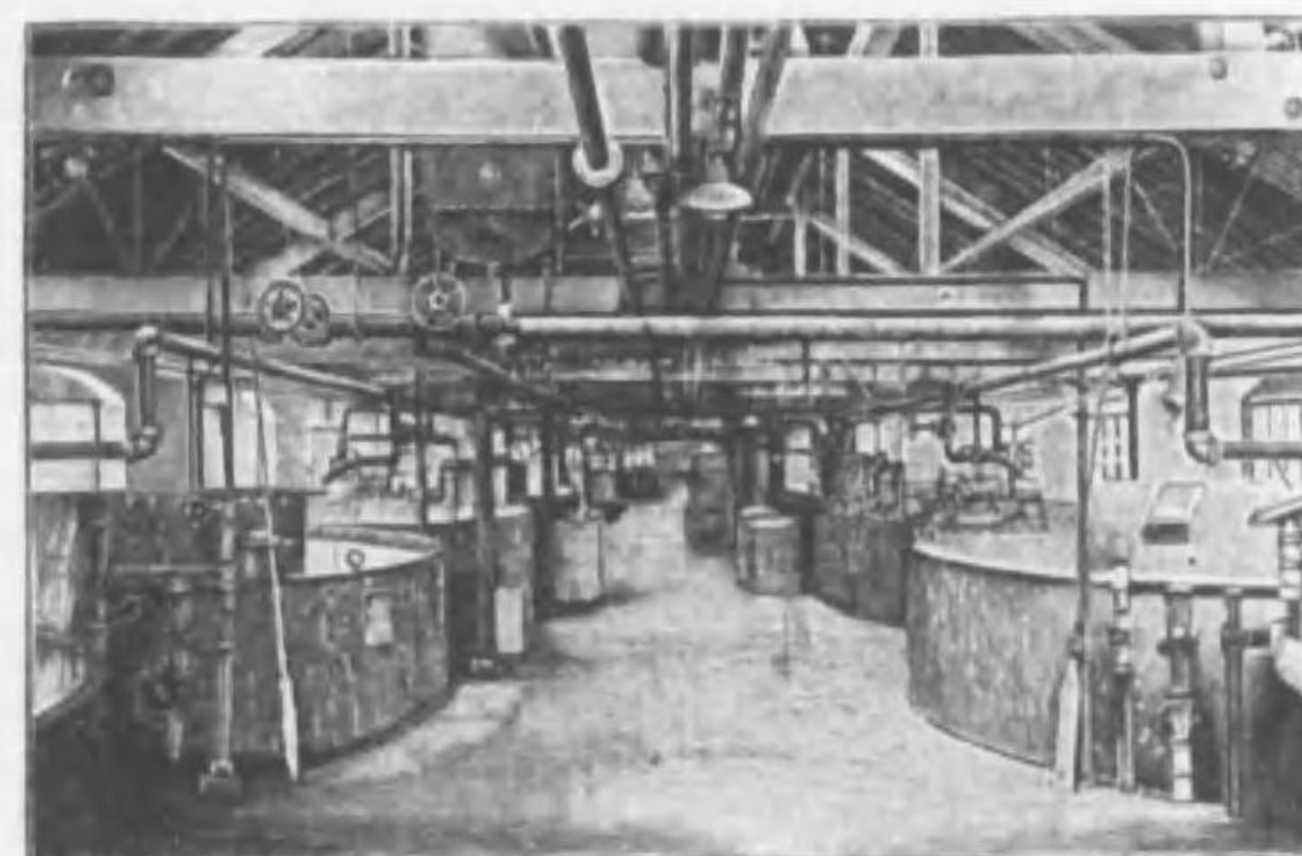
126. 鹼 化 釜 タンクのやうな釜で石鹼を煮る
