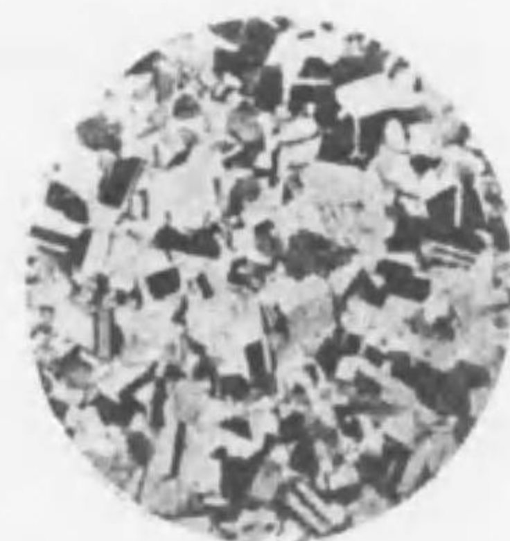
100. 合金の顯微鏡組織 亞鉛34%を含む黃銅
