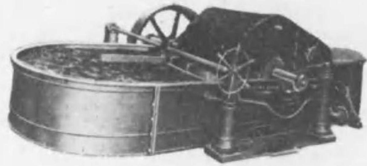
159. 叩解機 パルプを調製して抄紙機へ送る
