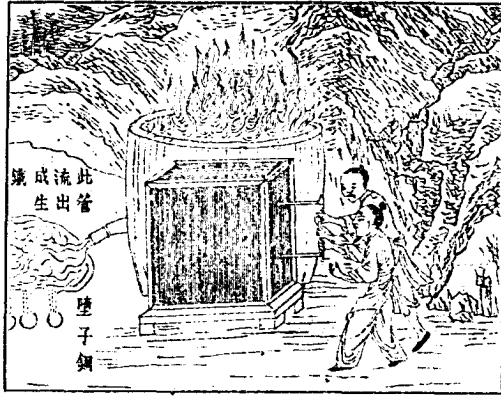
化鐵爐與風箱圖 (探天工開物)
