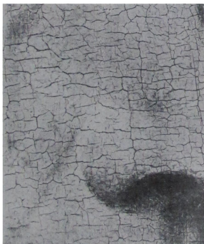
Resquebrajaduras en «tela de araña» o en escamas. (Examen óptico).
