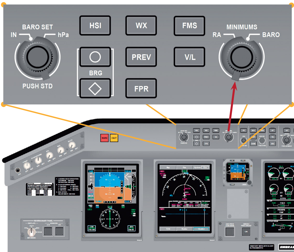
Figuur 1: Locatie van de BARO/RA instelknop op het instrumentenpaneel (zie rode pijl). (Foto: Embraer)
