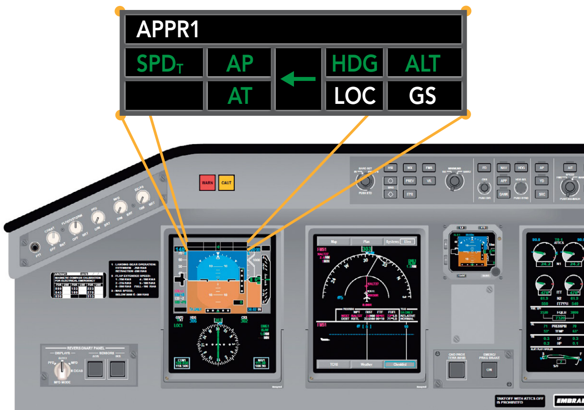
Figuur 2: Locatie van en indicaties op de Flight Mode Annunciator (FMA) op het instrumentenpaneel. (Foto: Embraer)
