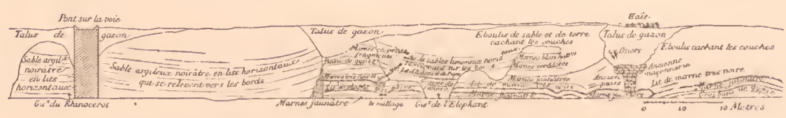
Fig. 7. — Tranchée du chemin de fer d'Argenteuil à Sannois, avant son muraillement (Fig. extraite de « La Nature », XI e année, 2 e sem.; n o 537, 15 septembre 1883, p 251).
