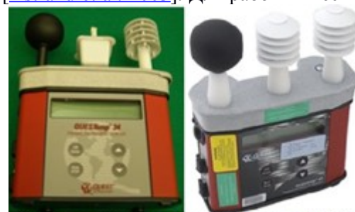
Прибор для измерения показателя температуры WBGT
