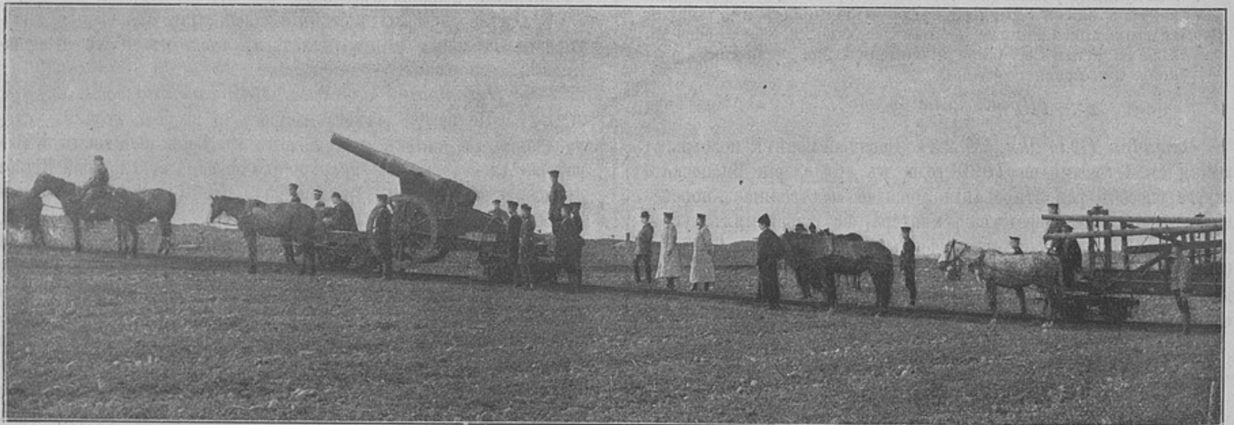
Подъемъ на гору 6-ти-дюймовой пушки въ 120 пудовъ, стоящей на платформѣ, укрѣпленной къ двумъ вагонеткамъ, при помощи шести лошадей.
