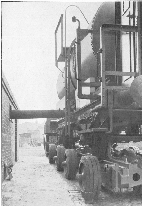
Bild 55. Schlauchverbindung des Kesselwagens mit dem Tankkeller der Firma Gebr. Asmussen, Elmsborn
