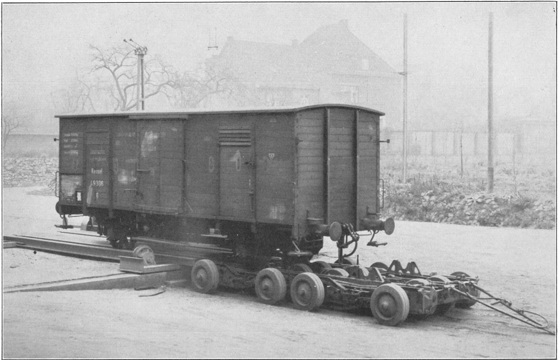
Bild 13. Das Absetzen eines gedeckten Güterwagens vom Straßenzug auf die vordere Schiebebühne im Werkhof der Schokoladenfabrik (Firma Kaiser, Viersen)
