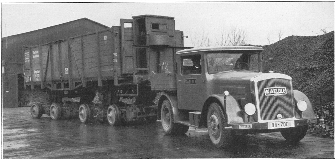
Bild 30. Zufuhr der Kohlen mit der Eisenbahn ins Haus bei der Firma Kugelfischer, Schweinfurt
