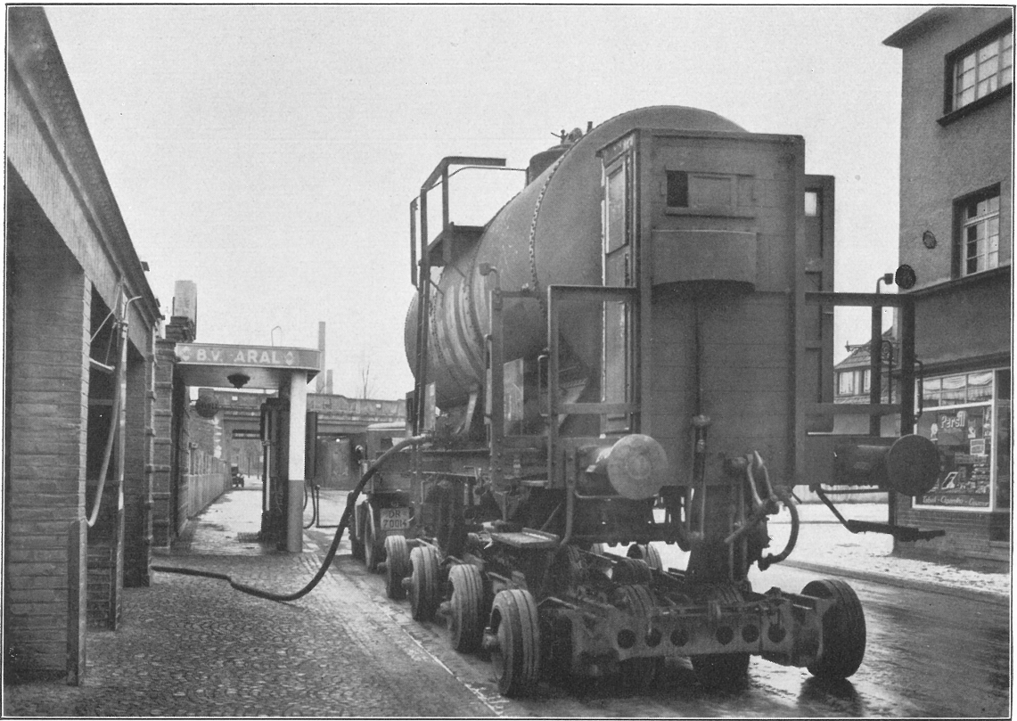
Bild 25. Entleeren des Kesselwagens an der Tankstelle
