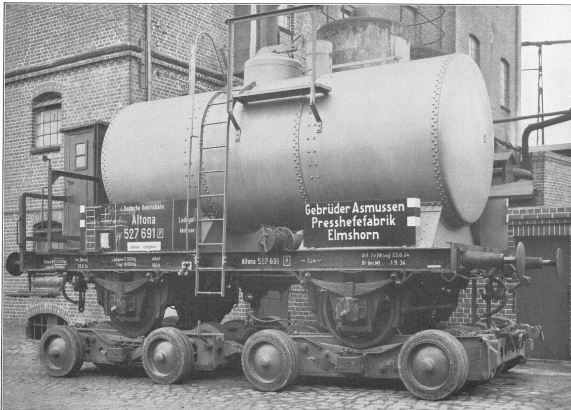
Bild 54. Heute erfolgt die unmittelbare Zu- fuhr der Kesselwagen mittels Straßentrans- ports der Reichsbahn nach dem Werkhof der Fa. Gebr. Asmussen, Elmshorn
