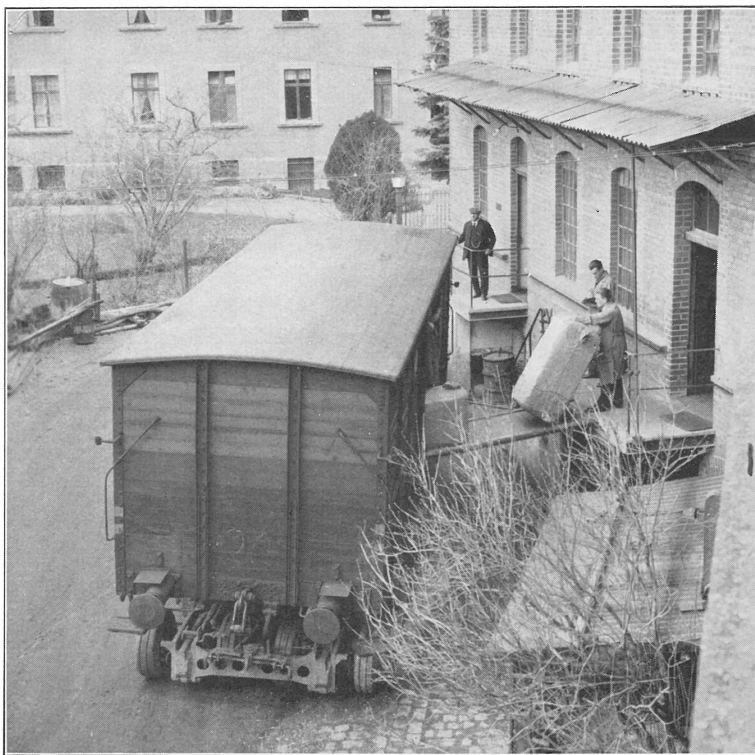
Bild 50. Einladen von Wolldeckenballen in den auf dem Straßenfahrzeug stehenden G-Wagen auf dem Werkhof der Ascherslebener Wolldeckenfabrik
