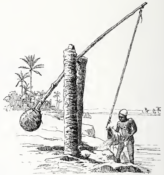
Fig. 8 b. Wasserschöpfer (Schaduf) aus Oberägypten.
