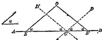
AB為所設直線求從AB外之一點O向AB引一直線,令此直線與AB所成之角等於所設角 $\alpha$ 。
