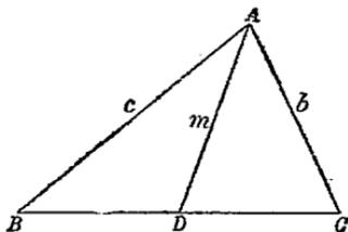
從定理十四，  $\overline{AB}^2 + \overline{AC}^2 = 2(\overline{AD}^2 + \overline{BD}^2)$ ，
