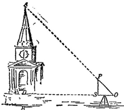
在地平面  $BC$  上取適宜之位置置一几, 令几面與地平面平行; 几上置一直立之三角板  $POS$  ( $S$  為直角), 置眼於  $O$  以望  $A$ , 進退几面, 使  $O, P, A$  可在一直線上。
