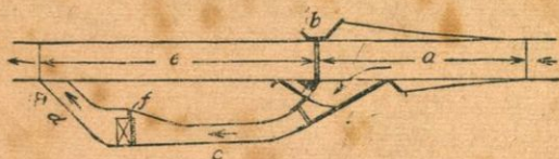
a. 水面抬高區 b. 攔水壩 c. 進水道 d. 尾水道 e. 水量被引用段
