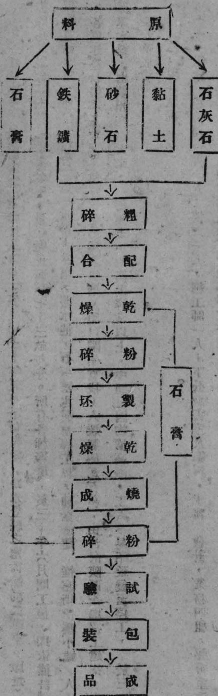
右圖所示製造之程序，在工作方面，除粉碎部份外，其大部爲手工操作，而處理之難，則以燒成段爲最，風力之大小，溫度之高低，燒成之火候，均須適度，非有熟練之技工，不能勝任，此爲該廠開工之初最感困難者。
