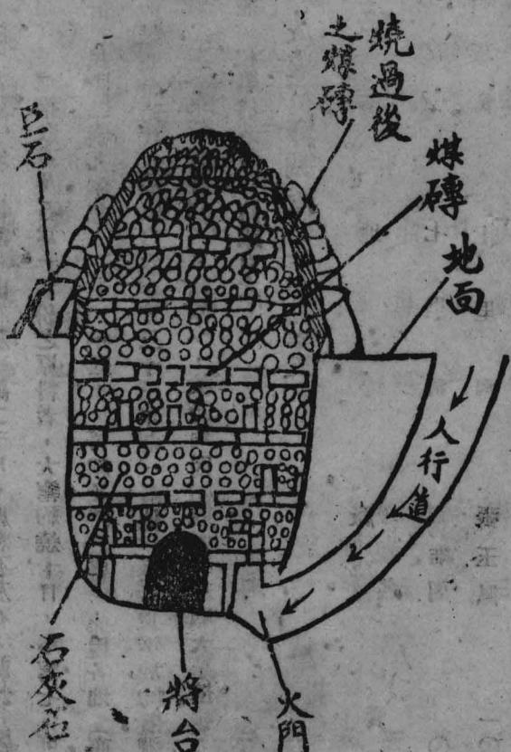
穴深約七市尺，上寬下狹，直徑約六市尺，穴之四周，塗以紅土，穴底中央部築一土墩，名曰「將台」，以備架立煤磚及石灰石之基礎。（煤磚即以四成煤屑，六成紅土，以水調和，作成磚形，晒乾即成，每塊重約十二斤）。底留一孔，以備舉火之需。裝窯先在將台旁架立煤磚一層，然後在其上裝置石灰石一層，約一尺許，再敷以一層煤磚，如是裝
