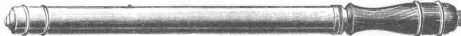
Nr. 13171. Handluftpumpe aus Messingrohr, fein vernickelt und poliert. Diese Pumpe eignet sich nicht nur für den Hausgebrauch, sondern auch zum Mitnehmen am Rade, da sich dieselbe mittels der Pumpenriemen Nr. 299 oder Nr. 12274 bequem am Rahmen befestigen läßt. Der Pumpenschlauch ist im Griff untergebracht. Ganze Länge der Pumpe 40 cm, Rohrdurchmesser 24 mm. Hierzu paßt Pumpenschlauch Nr. 1617. Stück 90 Pf.
