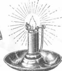
Nr. 4221. Tischfeuerzeug mit Cereisen-Zündung in fein vernickelter Ausführung. Man hat nur nötig, den Verschlussdeckel über dem Benzindocht zu öffnen und den Federbügel anzudrücken, wodurch Funken und Flammen erzeugt werden. Höhe 8 cm. Stück Mk. 2.10
