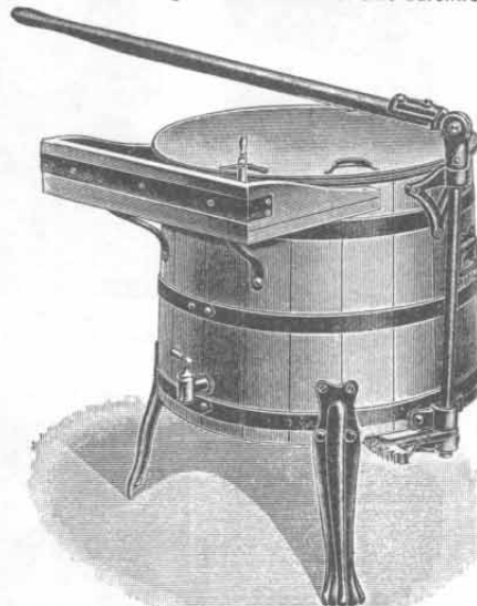
Nr. 5647. Waschmaschine „Vogtland“ , aus bestem Eichenholz in Nut- und Federausführung mit horizontalem Hebelantrieb und 2 Wäschebewegern. Leichte Handhabung durch Verstellbarkeit des Hebels. Tadellose innere Einrichtung. Oberer Bottichdurchmesser 530 mm, innere Bottichhöhe 400 mm, äußere Gesamthöhe der Maschine 780 mm. Inhalt ca. 60 Liter. Gewicht ca. 51 kg. Stück Mk. 46.50
