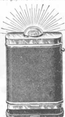
Nr. 1640. Elektrische Taschenlampe mit Vergrößerungslinse und seitlichem Kontakt, mit überfassendem oberen Deckel und unterem Scharnier-Klappboden, wodurch die Batterie bedeutend fester sitzt. Größe 95x65x24 mm. Stück 95 Pf. 4,5 Volt.
