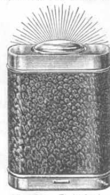
Nr. 3891. Elektrische Taschenlampe mit guter Batterie und Metallfadenbirne. Hülse vernickelt mit krokodilmustertem Papier beklebt. Mit dreifachem Kontakt, nämlich Moment- und Dauerkontakt, sowie Verriegelung des Schiebekontaktes während des Tragens in der Tasche. Größe 90x65 mm. Stück 90 Pf.
