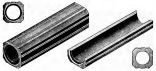
Fig. 332.-Single-Duct Conduit.
