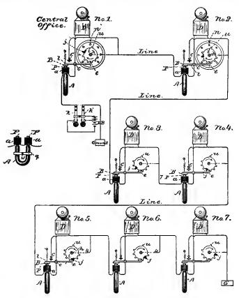
Fig. 252.-Lockwood Step-by-Step System.
