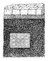
Fig. 337.-Twelve-Duct Cement Arch Conduit.
