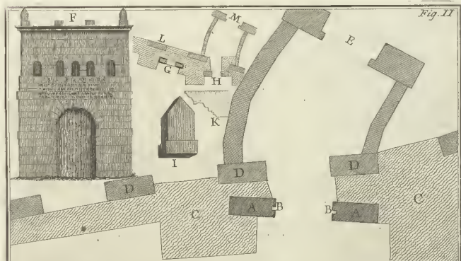
A. Porta s' Lorenzo di Anagnino. B. Canale per uso della porta levatora a costume di que tempi. C. Mura, e torri di Belliario. D. Acquedotto dell'Acqua Marcia. E. Porta interna. F. Facciata della porta. A. in tutto simile alla chiesa C. vicina alla Magg. H. I. Merli della Porta E. in forma più grande. K. Modinatura della Cornice. L. Acquedotto dell'Acqua Claudia. M. Porta interna alla Maggiore. Piranesi Architetto. del. inc.
