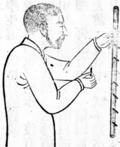
前面說的氣有壓力 不知水也有壓力 氣的壓力愈低愈重 水的壓力也是如此 譬如水有二尺深 則水底壓力 比水面壓力加倍 故從水面量到水底 有多少深 壓力即加多少倍 且水的壓力 也同氣一樣 不但以上壓下 並可壓的從左右四面橫出來 假如用一玻璃直管 每寸有一小孔 皆用木塞塞住 管內滿盛着水 試先拔最上小孔之木塞 水出小孔即流下 無甚壓力 再拔第二層木塞 水有三寸壓力 出小孔比第一層稍遠 若拔第三層木塞 水出更遠 總之低一層 水出遠一層 愈低水愈多 出來愈急 激出愈遠 這就是水的壓力也
