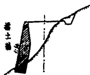
第39圖 石牆護坡。
