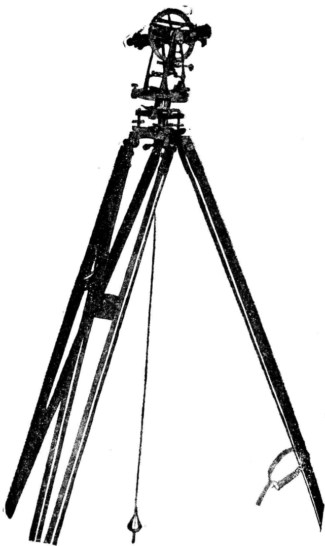
第二十圖 裝在堅固三腳架之上轉鏡經緯儀
