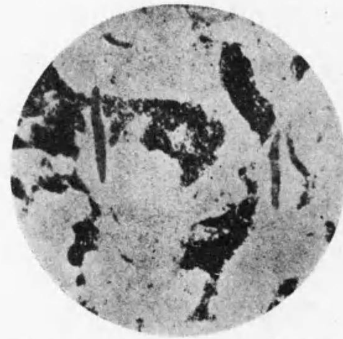
鍛鍊せる軟鋼中の硫化滿俺 (230倍)
