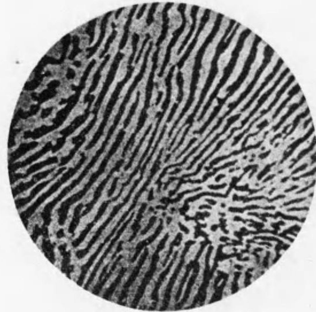
層狀波來土組織 (1100倍) (黑色 セメントタイト) (白色 フェライト)
