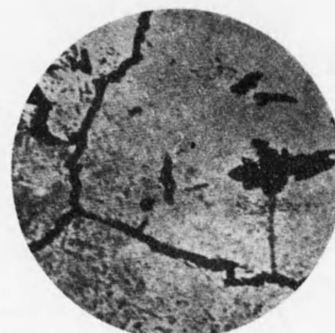
過共析鋼(試薬—ソヂウムピクレート) 白色 波來土 黑色 セメンタイト
