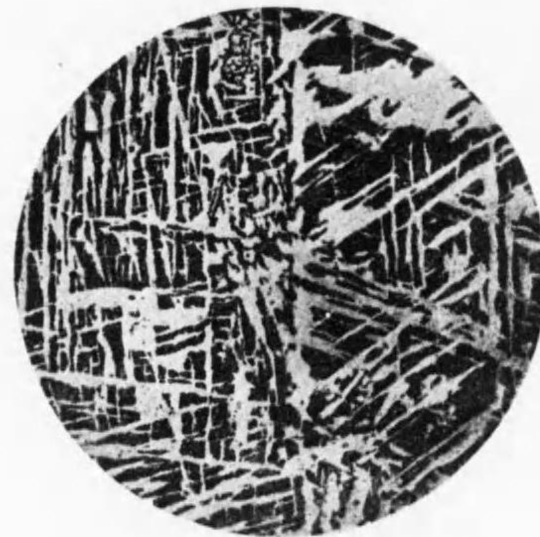
0.35% 炭素鋼塊 樹枝状組織 (第八十六圖(一)及(二)の組織を示す) (38倍)
