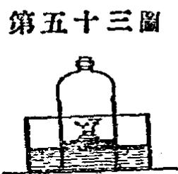
第五十三圖 (第五十三圖)以一熱鐵鉗與之觸，使燃。立即罩以玻璃罩。使一部分之空氣，閉入其中。磷與氮化合而成五氮化磷。此為白色之固體。迷漫於罩中，漸為水所吸收。氫則獨存。氮之減少，即自水之升起而知之。惟有時氮不能盡去，不如用銅法之為得也。
