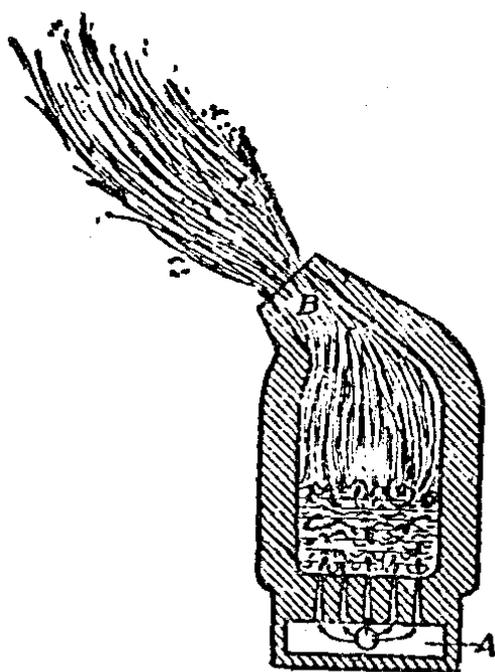
持高溫度不變。爐口有火焰，且噴射火星。有經驗之工人，望火焰之外形而知氫化之程度，及時停風。再加所需之炭(平常爲炭鐵之合金)使合所求之成分；略鼓風，使混和。然後傾入模型(第百五十三圖)。鑄成鋼塊，或錘成鋼條。此法需
