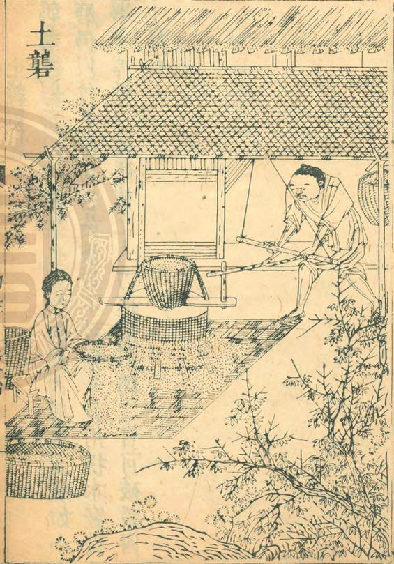
礮礮穀器。所以去穀殼也。編竹作圍。內貯泥土。狀如小磨。仍以竹木排為密齒。破穀不致損米。就用拐木竅貫礮上。掉軸以繩懸檣上。人力運肘以轉之。日可破穀四十餘石。
