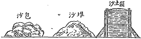
蓋部遮蔽之防護破片
