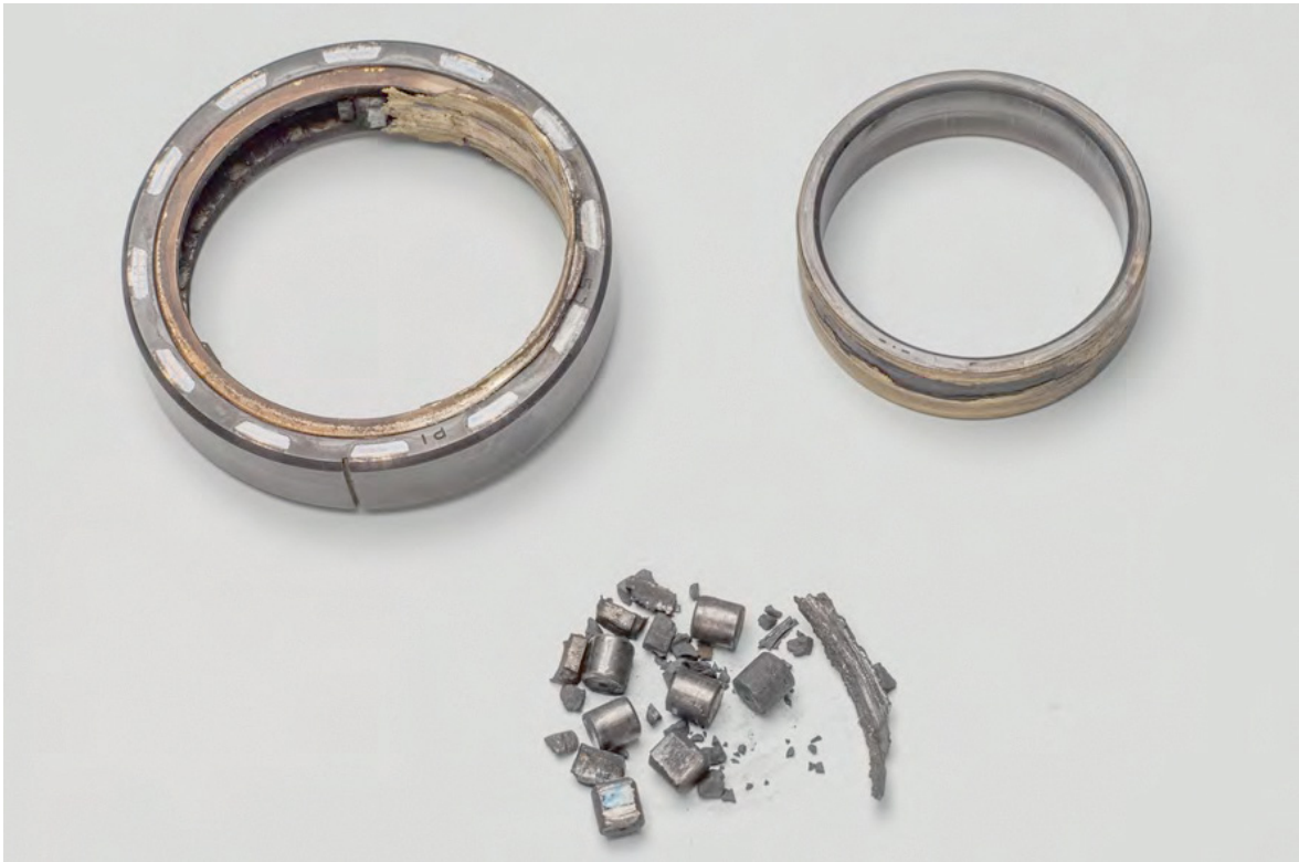
Figuur 4: De defecte voorste rollager. (Foto: NLR)
