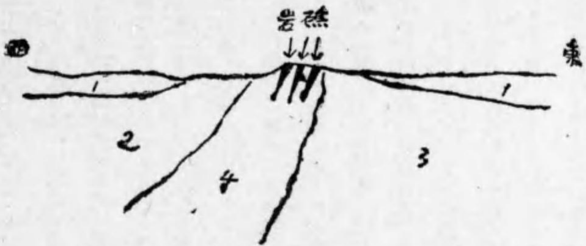
第十六圖 西オーストラリア州リオーラ金山断面圖 1 近代層 2 閃綠岩 3 花崗岩 4 綠岩、片岩等
