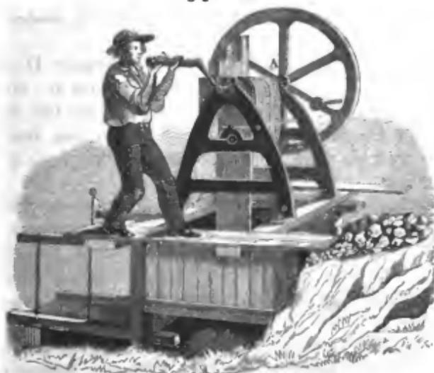
zeigt. Ein starkes gußeisernes Gestell trägt auf seiner obersten Krümmung eine Achse AB, die durch einen Mann gedreht werden kann. Ist die
