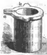
vorspringende Lappen, an denen er mittelst einer sogenannten Teufelstralle gefaßt werden kann.
