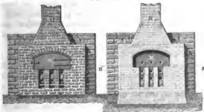
über den vertieften Kanälen steht, wie es bei dem Saigerprozeß über der Saigergasse aufgestellt ist.
