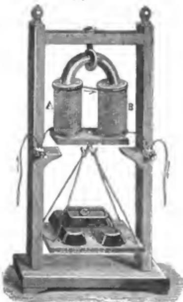
Je stärker der elektrische Strom ist, desto mächtiger wird der Magnet (von weichem Eisen immer nur für die Dauer der Strömung, von Stahl dagegen für Jahrhunderte, wenn nicht Rost oder Ausglühen den Magnetismus zerstört), und je mächtiger solch ein Magnet ist, desto gewaltigere elektrische Kräfte vermag er zu erzeugen.
