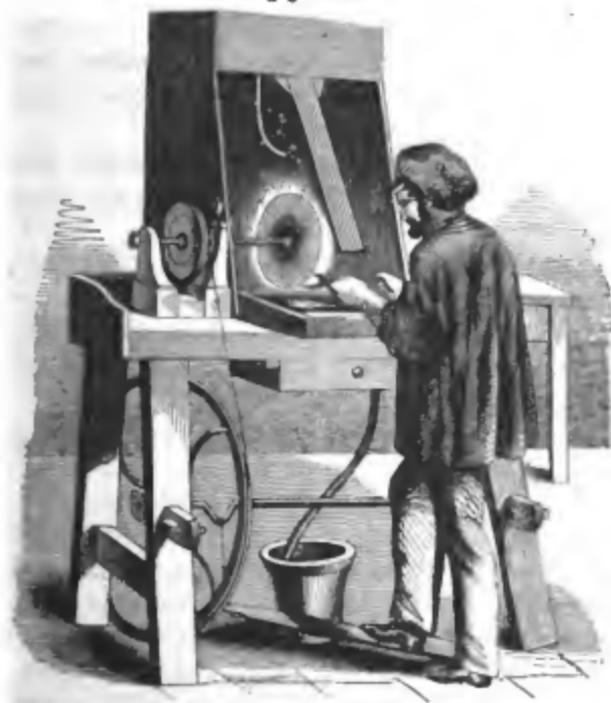
Wir sehen hier auf Fig. 1070 eine ganz gewöhnliche Drehbank, durch welche die Bürste mit einer beliebigen Schnelligkeit im Kreise umhergeführt werden kann, oben über derselben befindet sich ein Gefäß mit der ätzenden Flüssigkeit, mit der verdünnten Säure, welche durch einen Schlauch gerade auf die Bürste fließt. Durch einen Hahn kann natürlich dieser Zufluß beliebig regulirt werden.
