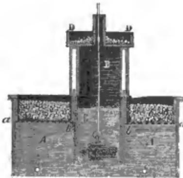
Fig. 944 zeigt uns in A einen viereckigen Wasserbehälter von ungefähr 3 Fuß Höhe, durch welchen quer hindurch ein starkes Sieb ab geht, auf dasselbe werden die zerkleinerten Erze geschüttet. Das Sieb ist in der Mitte unterbrochen und es befindet sich an dieser Stelle ein zweiter, gewöhnlich runder Kasten B, der unten offen, oben dagegen geschlossen ist. In diesem Kasten, welcher als Pumpe wirken soll, befindet sich ein Stempel P, den man durch eine Stange emporziehen kann, der Stempel schließt
