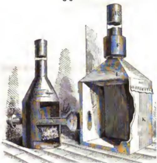
derselbe soll starken Zug hervorbringen, da aber in dem Raume N kein Feuer ist, so wird dieses sehr schwer werden, deshalb umgiebt man den Rauchfang unten mit einem Feuerbecken F, das darin brennende Feuer muß sich seine Nahrung aus dem Trichter und folglich aus dem inneren Raume von KN holen und so folgt, daß die durch das Feuer bei B erzeugten Dämpfe des Calomels durch die Röhre D gezogen werden und in den Raum N gelangen.
