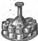
Wenn auf diese Weise die Metalle gänzlich aufgelöst sind, so bläst man in jedes Gefäß durch ein Glasrohr Luft hinein, um die Dämpfe von salpetriger Säure zu verjagen.
