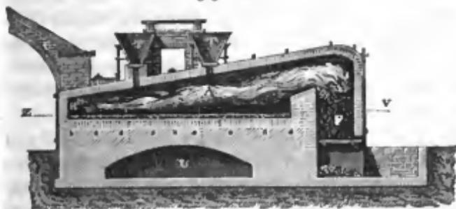
die Trichter T das mit Salz gemengte, genügend zerkleinerte Erz, vertheilt dasselbe so sorgfältig als möglich und heizt den Ofen durch Beschickung des Herdes F langsam an, zuerst entweicht nur die Feuchtigkeit, nach und nach aber steigert man die Hitze bis zum Glühen, wobei Zersetzung eintritt, es entwickelt sich schweflige Säure und die Metalle, welche einen großen Theil des Schwefels verlieren, verbinden sich mit dem Sauerstoff.
