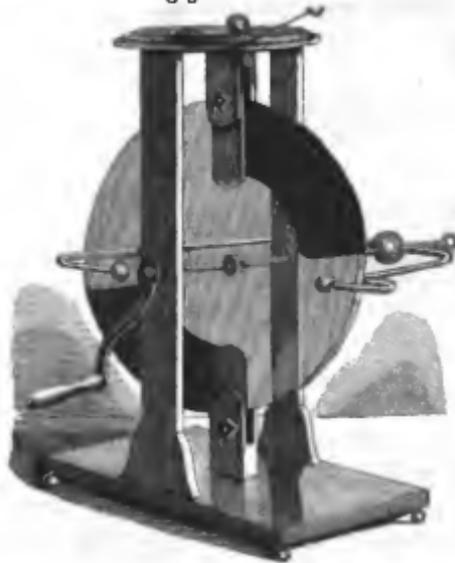
gewählt. Wir sehen dieselbe hier zwischen zwei Leisten auf einer gläsernen Axe, drehbar durch die Handhabe, schweben. Oben und unten sind die Reibzeuge angebracht, welche das Glas von beiden Seiten umfassen. Die Arme des Conduktors sieht man an beiden Seiten. Man hat noch andere Formen die Scheibe zu montiren, im Wesentlichen muß überall dasselbe geschehen, Glas wird gerieben, durch Metall wird die erregte Electricität aufgenommen.
