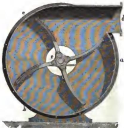
Durchschnitt, aus dem man auf den ersten Blick sieht, daß das Prinzip, nach welchem es gebaut ist, kein anderes als das der sogenannten Windsege, einer seit Jahrhunderten zur Reinigung des Getreides benutzten Maschine ist.
