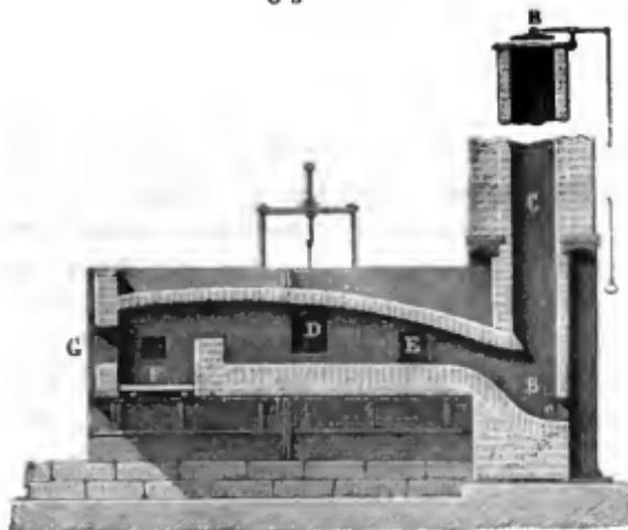
wie von einem Spiegel zurückwirft. Figur 964 zeigt uns einen senkrechten Durchschnitt desselben. Der Ofen hat eine horizontale Sohle, welche sich bei B beträchtlich abwärts senkt bis zu einer Oeffnung o, durch welche man die sich bildenden Schlacken fließen lassen kann.
