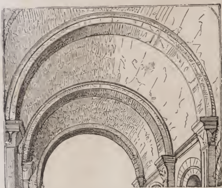
Fig. 83. Bóveda de medio cañon y arcos torales.
