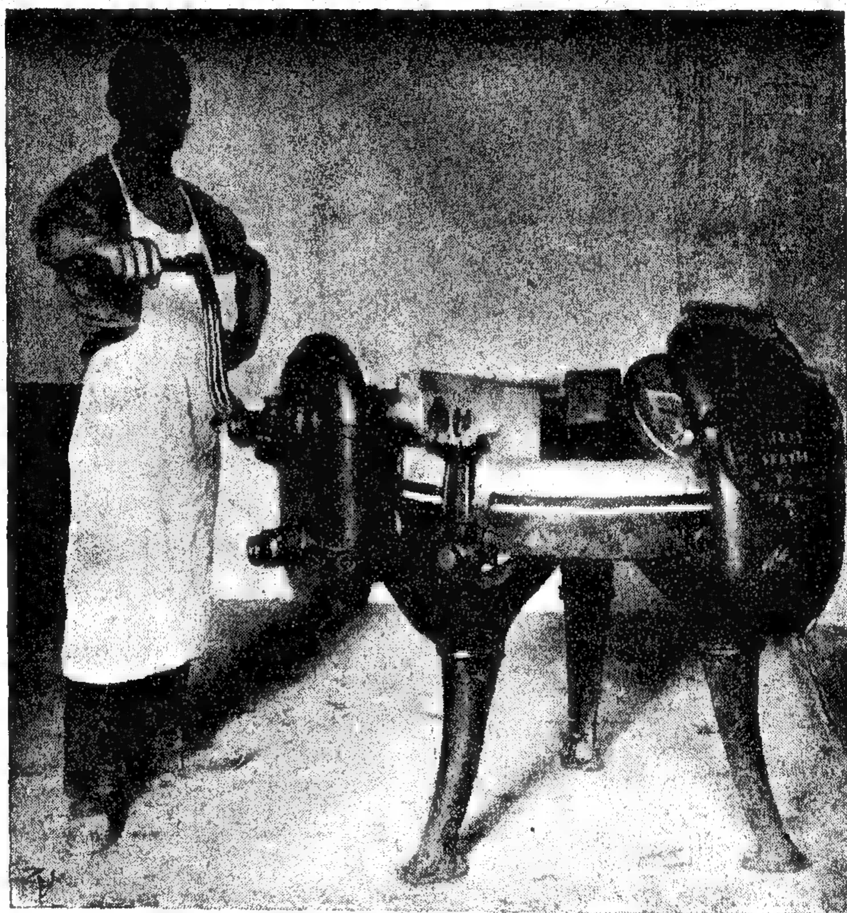
Impastatrice-rivoltatrice automatica del burro, tipo Astra.
