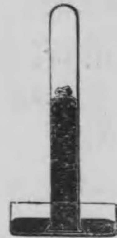
第81圖—水銀上に捕集せる氣體が燒きたるの木炭に吸着せらるゝを示す。
