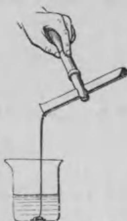
第 61 圖—沸騰せる硫黄を冷水に注ぎてゴム状硫黄を製す。
