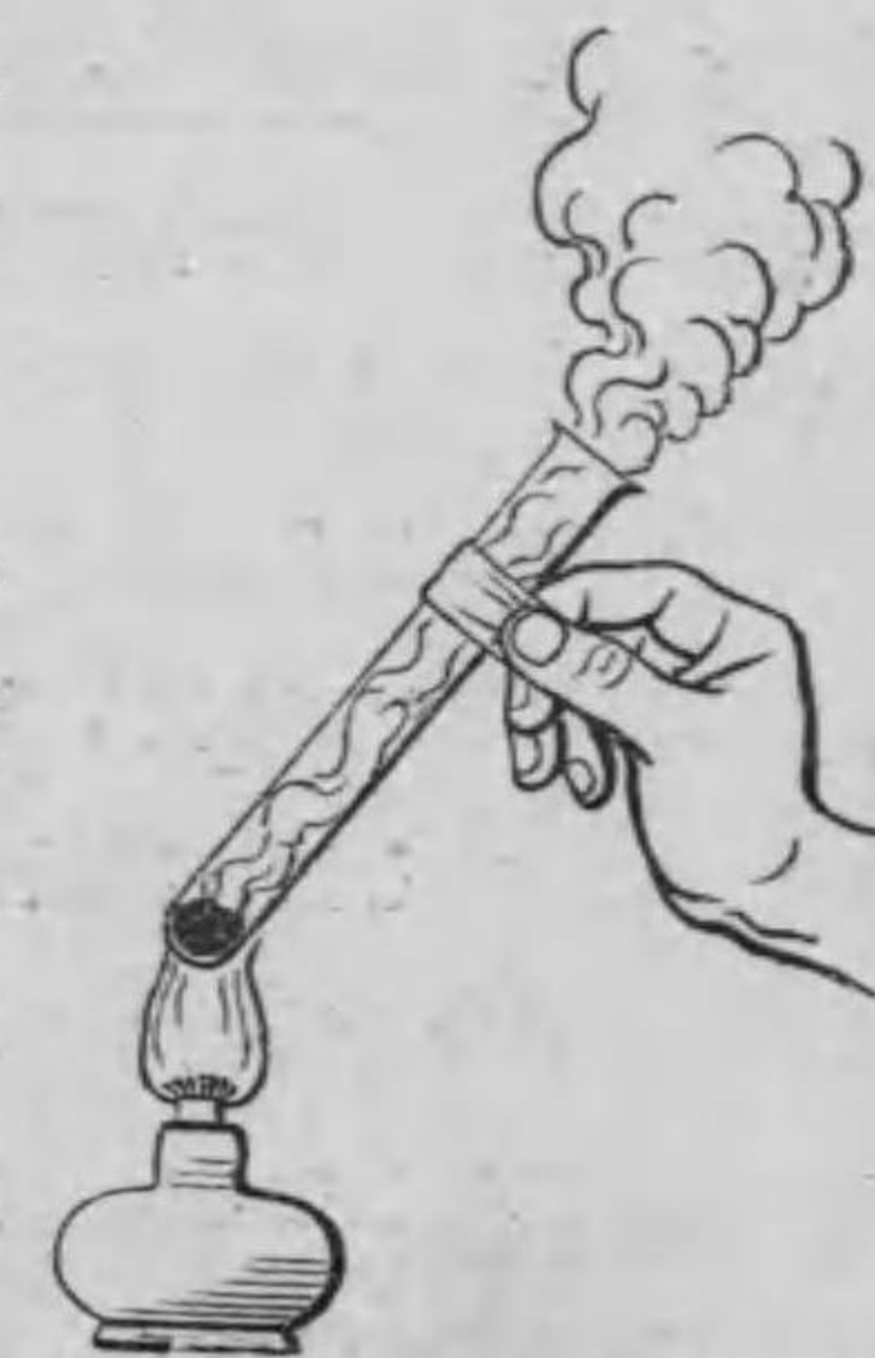
第 80 圖—木質を熱して炭化せしむ。
