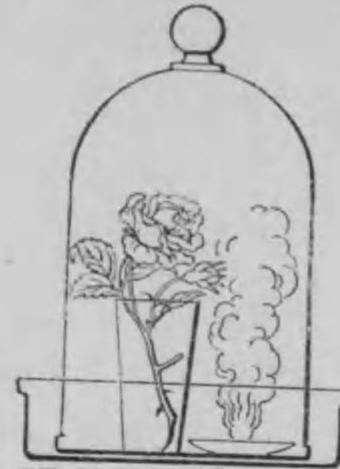
第65圖—硫黄の燃焼により生ずる無水亜硫酸にて草花を褪色せしむ。
