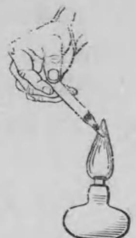
第77圖—無水亞砒酸に木炭末を混じて熱し砒素を昇華せしむ。
