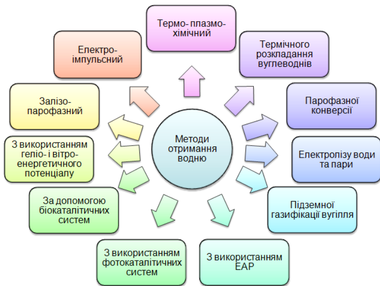
Рис. 2.1. Структурна схема основних методів отримання водню
