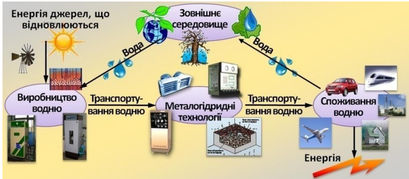
Рис. 1.6. Схема водневої енергетичної системи виробництва, енерготехнологічної переробки, зберігання і споживання водню
