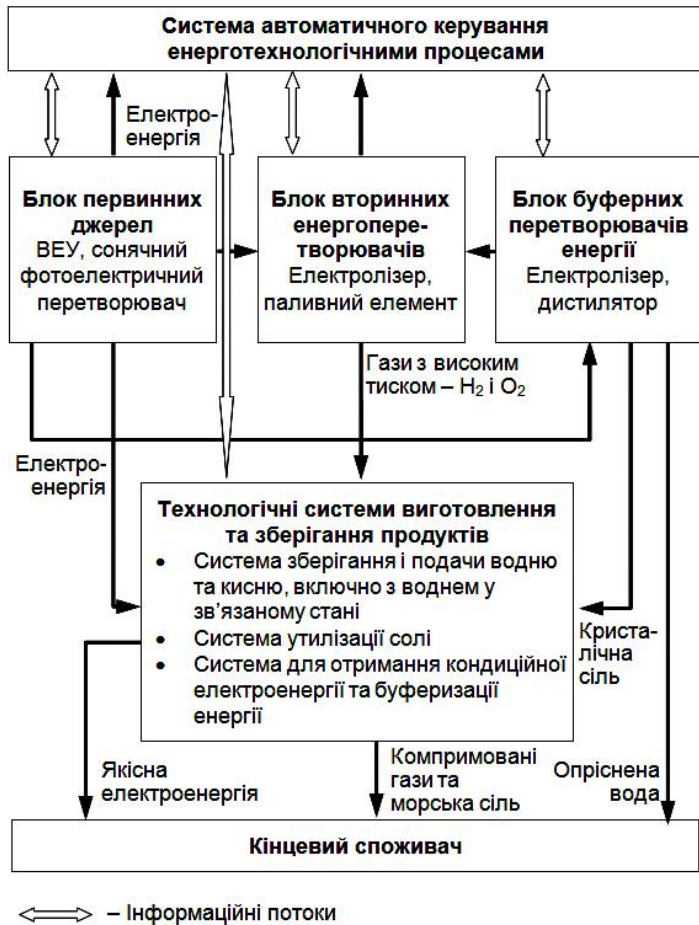
Рис. 4.4. Схема енерготехнологічного комплексу для виробництва екологічно чистих енергоносіїв і субпродуктів
