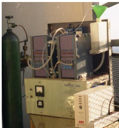
Рис. 4.6. Водень/повітряний паливний елемент потужністю 0,4 кВт
