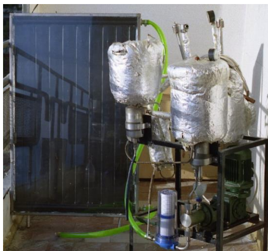
Рис. 4.8. Дистильатор води в зборі з сонячним колектором для підігріву морської води
