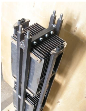
Рис. 3.27. Безмембранний електродний пакет для електролізера високого тиску
