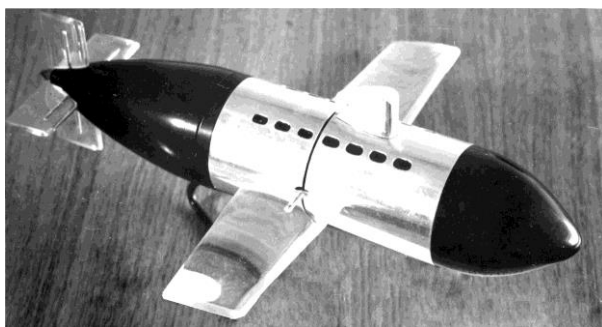
Рис. 2.18. Модель підводного човна з гравітаційно-підйомною рушійною системою [60]
