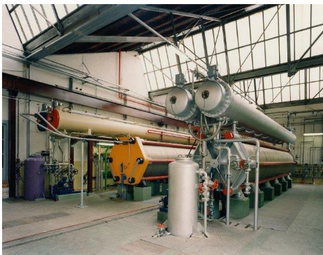
Рис. 3.21. Зовнішній вигляд електролізерів фірми LURGI
