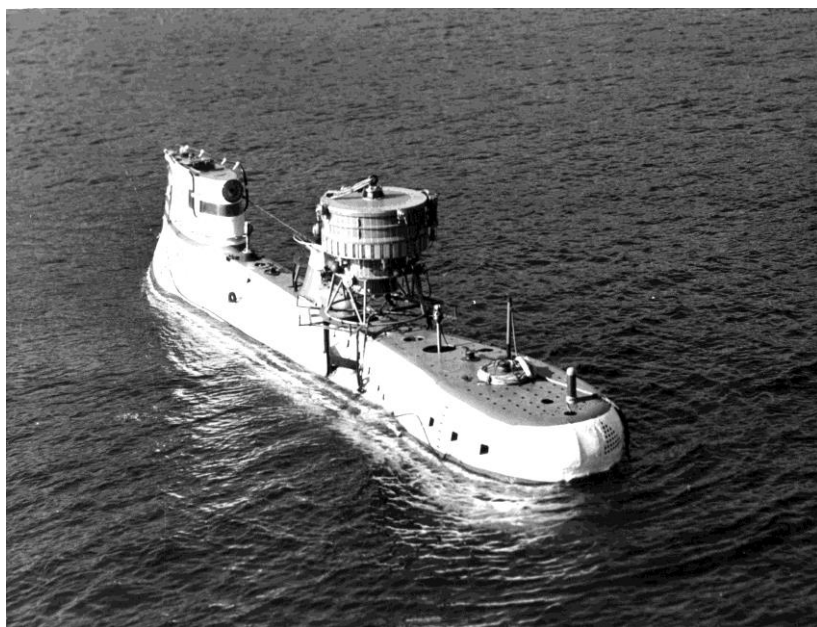
Рис. 2.13. Розміщення АПА на палубі підводної лабораторії «Бентос-300»
