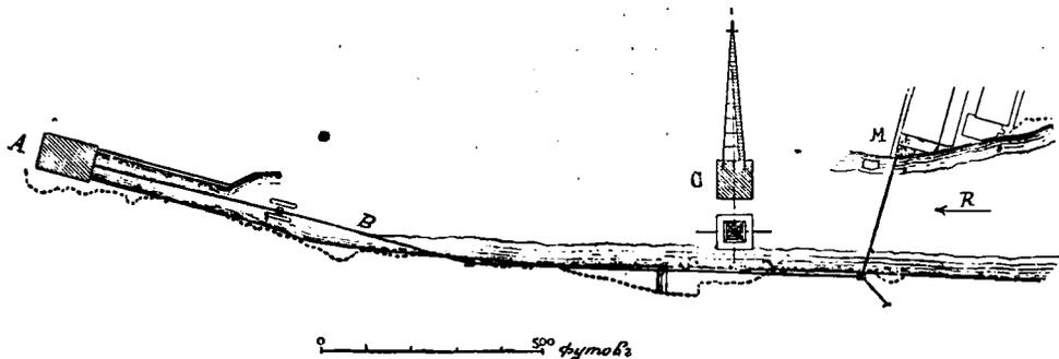
A—генераторная станція, B—кабель, C—кабельная башня, R—направленіе теченія Рейна, M—получательная станція.
