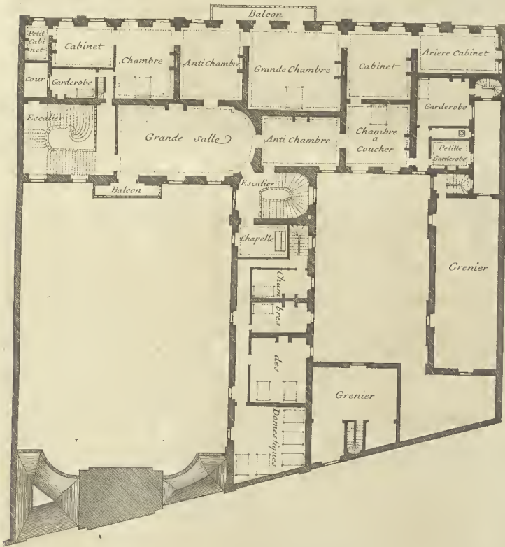
Plan du Grand étage d'une Maison à bâtir à Paris sur les desseins de M. Mansard.
