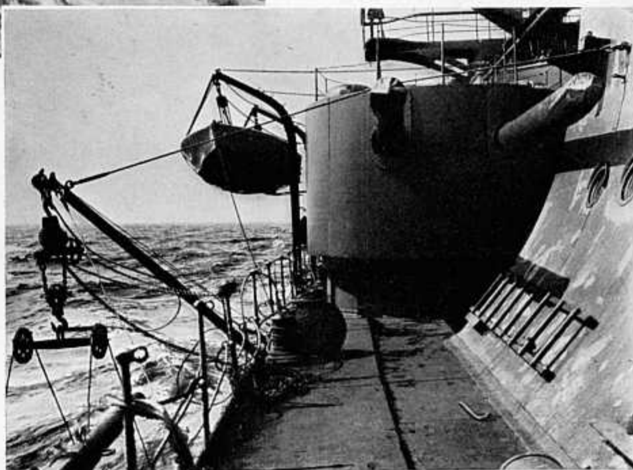
БОРТОВАЯ БАШНЯ ШЕСТИДЮИМОВЫХЪ ОРУДИЙ НА БРОНЕНОСЦѢ ТИПА «АЛЕКСАНДРЪ III».
