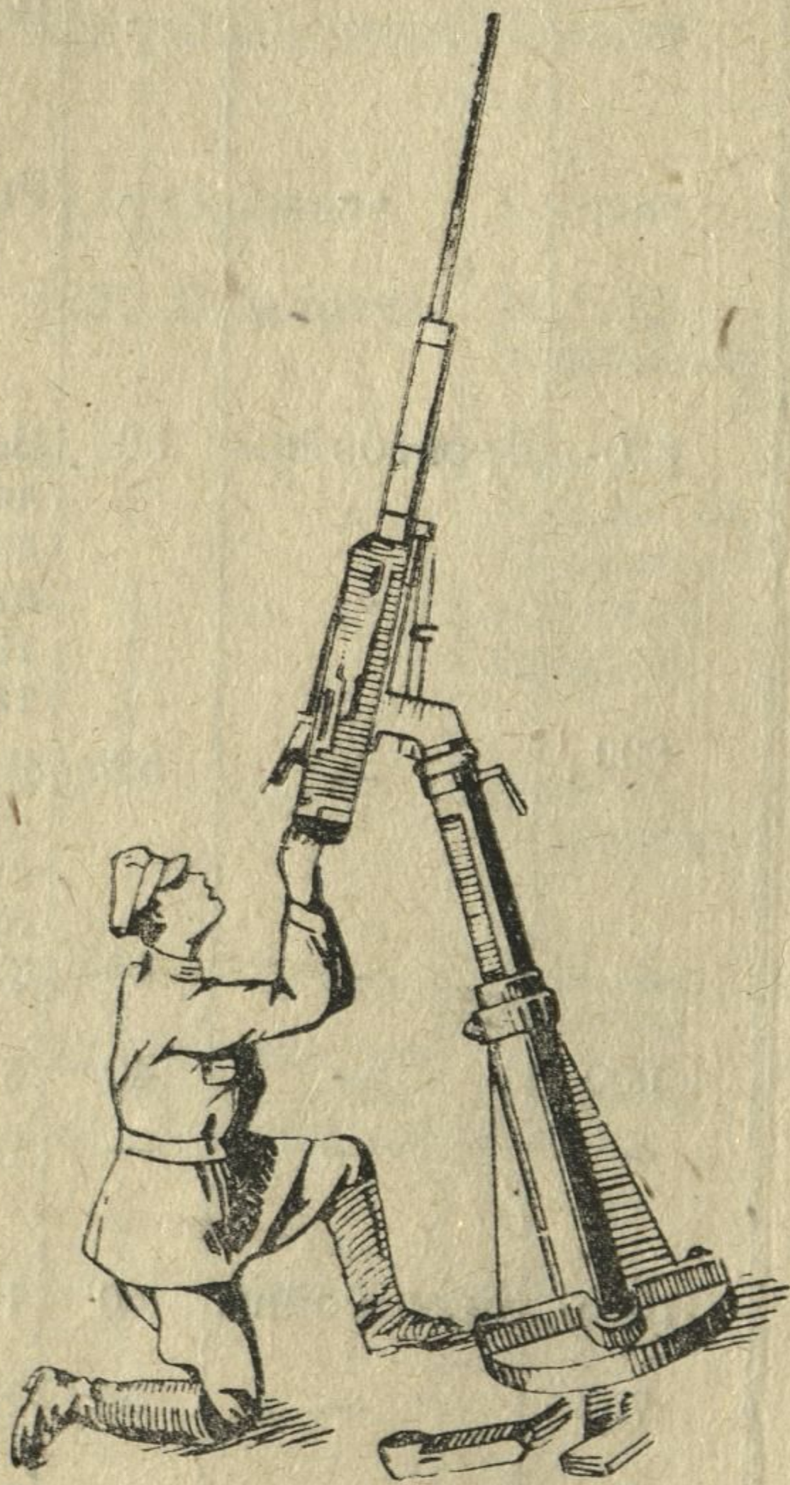
Чарц. 59. Італьянскі кулямёт Фіат калібра 12 мм на тумбавым станку для стральбы па наземных і паветраных цэлях.
