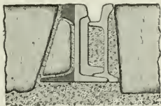
4. Wechselstegschiene mit Rillenschiene im Pflaster.
