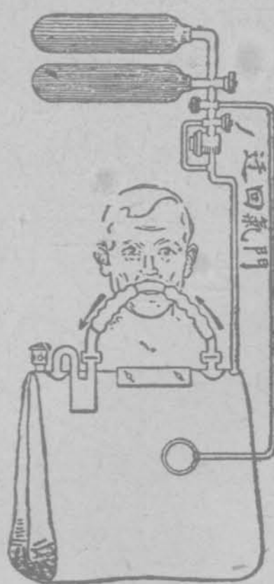
附圖 64. “撲羅多”器具 (附圖 63)之機能圖式。
