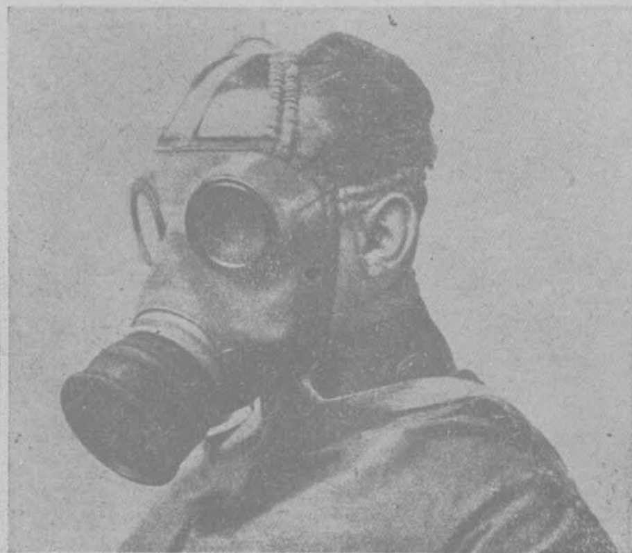
附圖 20. 大戰後之德國式工 業用防護面具。奧爾公司 之德加式第 747 號面具 (Degea-Maske Nr. 747 der Auer-Gesellschaft), 備有 小號之吸收罐者。
