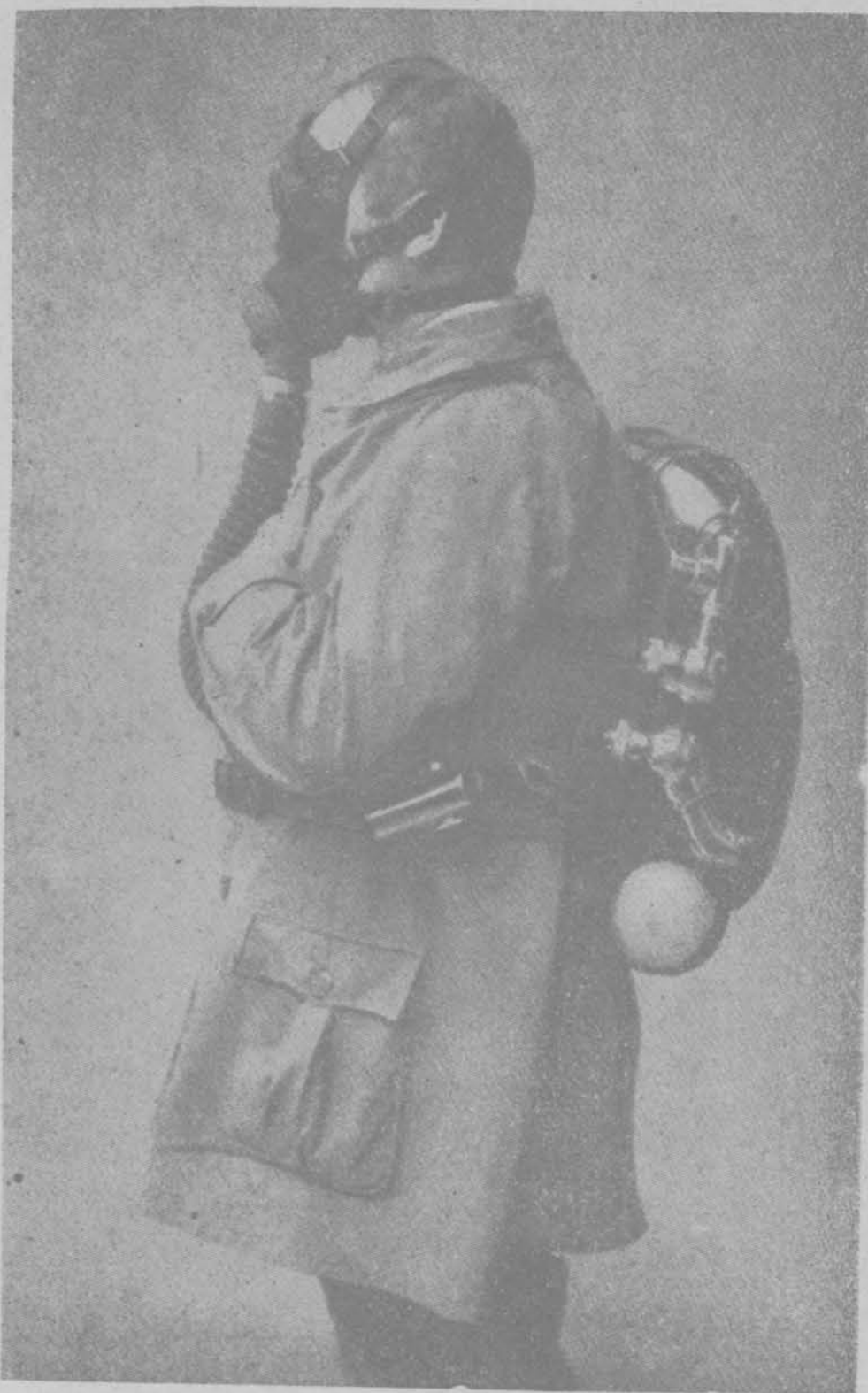
附圖 57. 第二號“奧多斯”器具(Audos Nr. 2) 韓賽亞器具製造公司之 1925 年模型，備有“阿不脫力”面具 (Optolix-Maske) 而可作二小時之用者。
