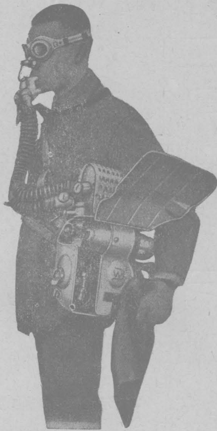
附圖 46. 1924 年模型 椎革 H. S. S. 式肺部 自動器具(Lungenautomatisches H.S.S.- Gerät nach Dräger)。
