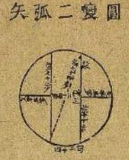
今有圓田一所不知頃畝端的直河一道正中間分弧矢兩段通徑七十四步二十四步河寬除河見在幾多田水占如何得見答曰見在田九畝八分九釐五毫六絲水占田七畝二分一釐六毫六絲
