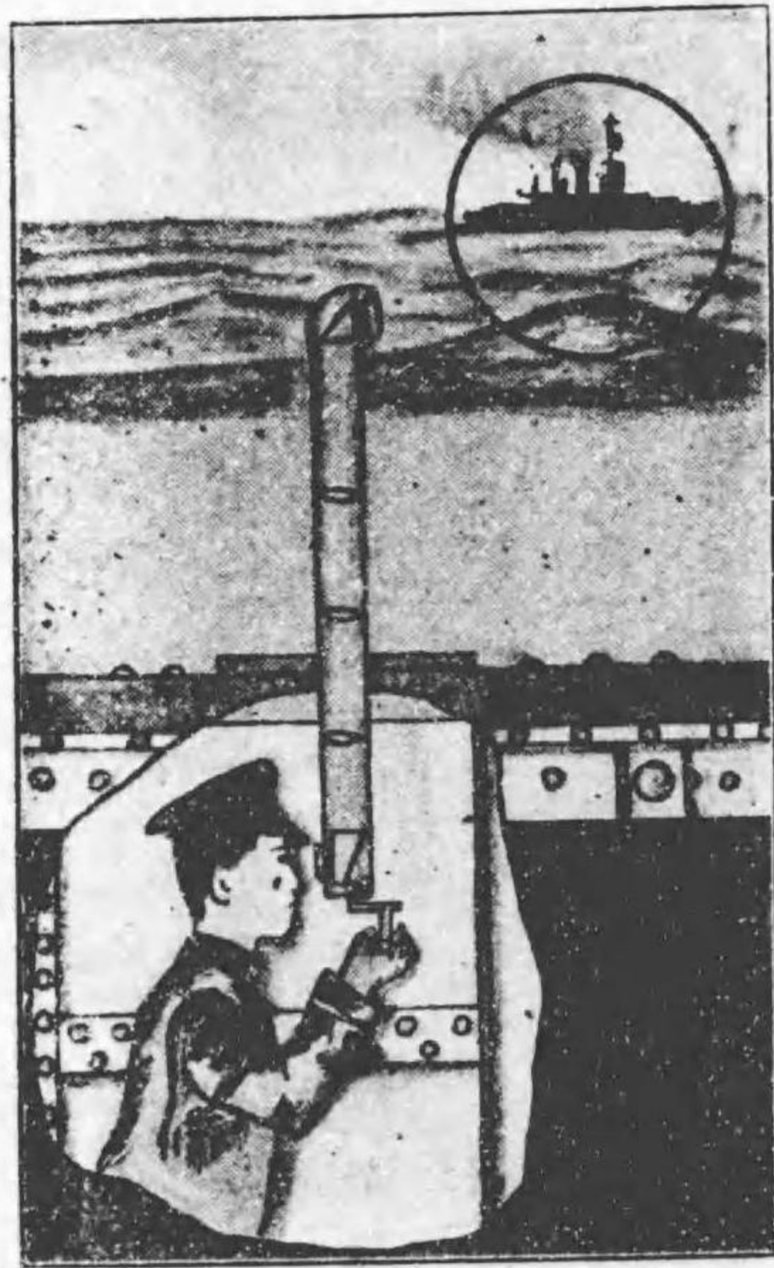
第八圖 潜る鏡の望遠鏡を塔内にて使用し、司令塔を司る
