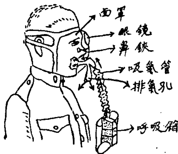
安全呼吸箱式面罩 (S.B. Respirator helmet.) 第二圖
