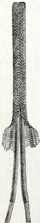
(Fig. 23.) Dubbele Bergmannsche draad.
