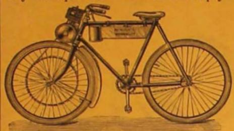
La Motocyclette est la seule bicyclette automobile réellement pratique. Poids total, avec moteur, carburateur et accessoires : 25 kilogrammes. Sa vitesse est de 25 à 35 kilomètres à l'heure, sans le secours des pédales. La force du moteur est de 3/4 de cheval et son poids est de 10 kilogrammes. Le Moteur WERNER peut être appliqué à toutes les machines. — Livraison immédiate.
