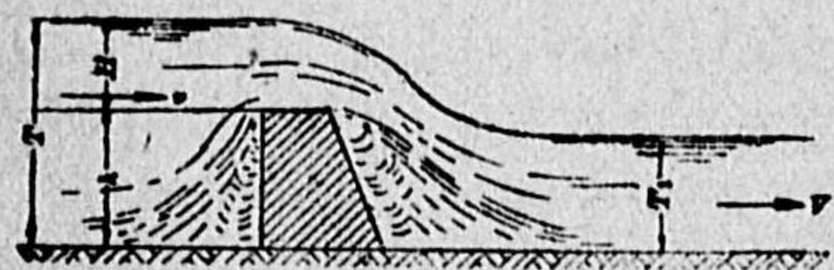
第331圖 完全溢流堰
