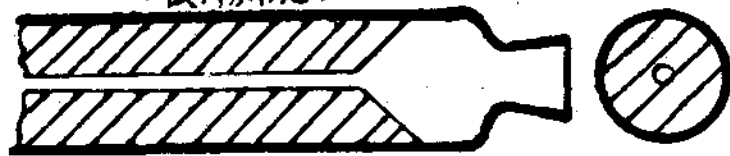
單藥柱由底端燃燒之火箭推進機 (限制燃燒)
